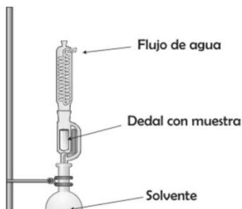
Figura 3. 46 Extractor Soxhlet. Fuente: (Linares, M., Villa, T. y Zapatero, J., 1993)
