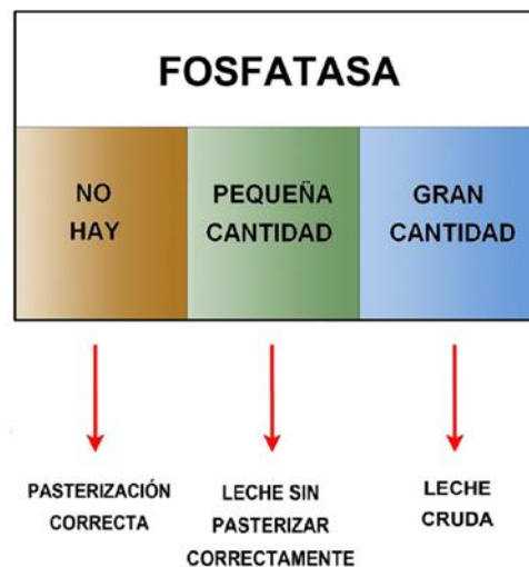
Figura 3. 23 Prueba de fosfatasa en la leche Fuente: (Lopez, L., Barriga, D., Jara, J. y Ruz, J., 2015)
