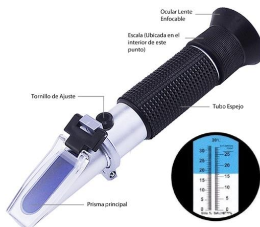
Figura 3. 30 Refractómetro y sus partes. Fuente: (TP Laboratorio Químico, 2021)
