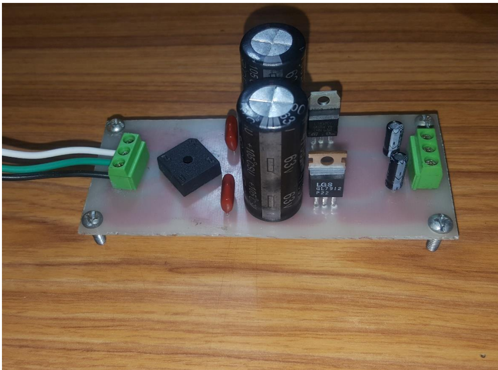
Figura 73: Circuito de fuente de voltaje de \pm 12V . [Elaboración propia]
