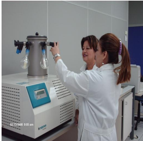
Figura N°17: Conectar los Balones al Liofilizador Testar Cryodos-50
