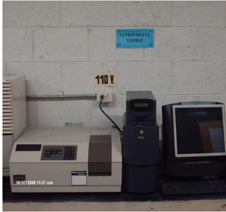
Figura N°21: Leer las absorbancias de filtrados a 280 nm en el Espectrofotómetro Ultravioleta- Visible
