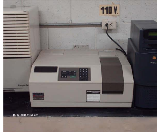
Figura N°21: Leer las absorbancias de filtrados a 280 nm en el Espectrofotómetro Ultravioleta- Visible
