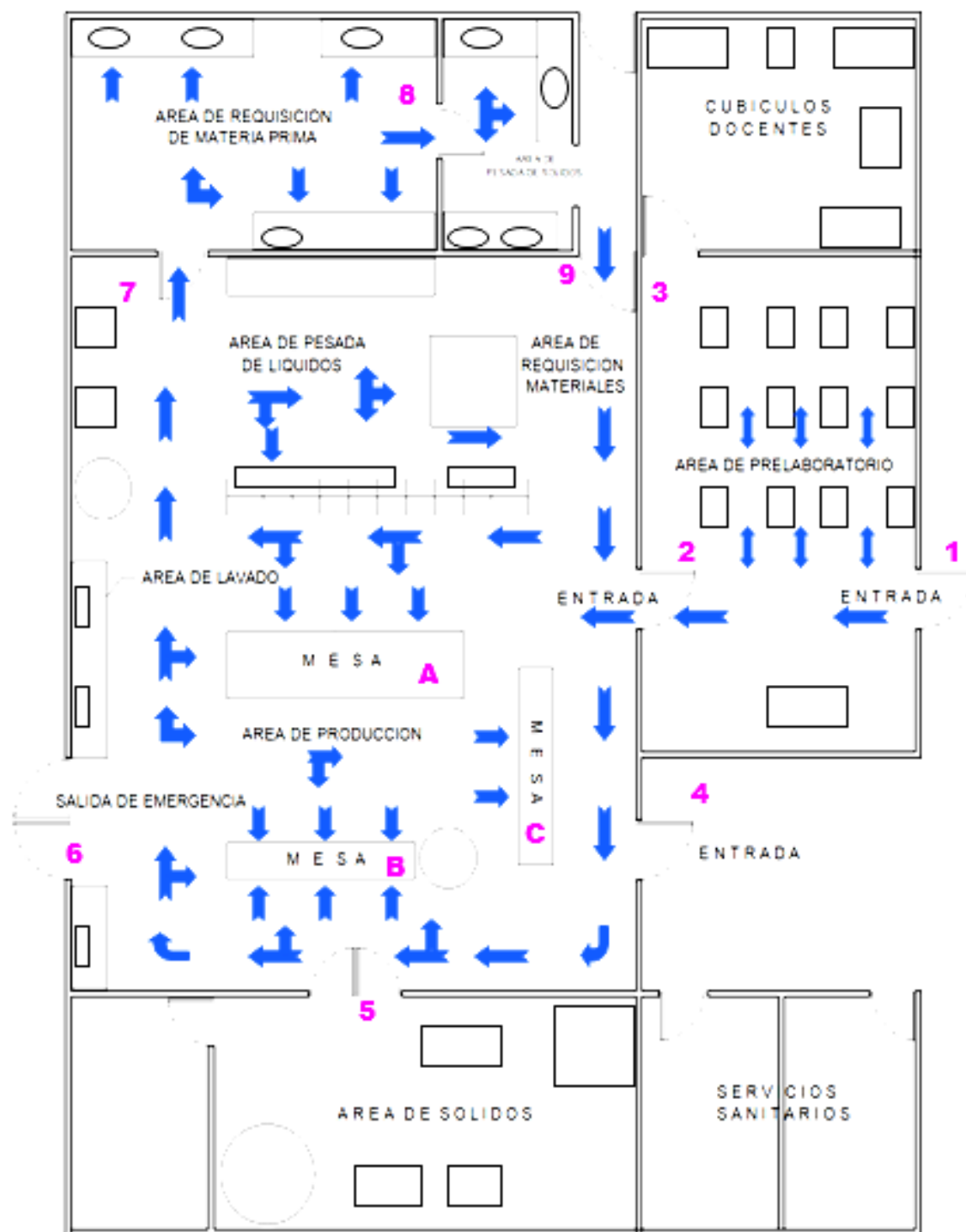
FIGURA N° 1 FLUJO DE PERSONAL LABORATORIO DE TECNOLOGIA FARMACEUTICA DE LA FACULTAD DE QUIMICA Y FARMACIA DE LA UNIVERSIDAD DE EL SALVADOR
