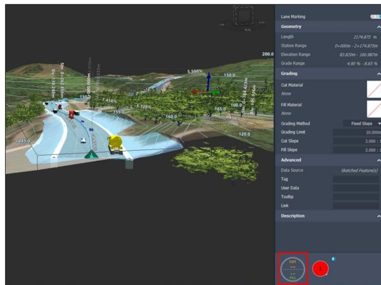
Figura. 208 Proceso para el cálculo de corte y relleno de nuestro modelo (Gustavo Andrade, 2021).
