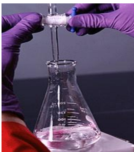
Fig. Nº 3 Punto final de la titulación por cambio de color
