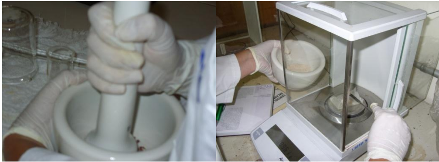
a) Trituración de tabletas y toma de pesos para cuantificar Hierro para los métodos Ultravioleta Visible, Absorción Atómica y Valoración Oxido-Reducción.
