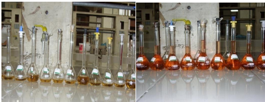
c) Preparación de muestras de tabletas y jarabes para ser leídas en el Aparato Ultravioleta Visible.
