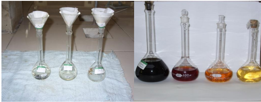
b) Filtración de muestras y preparación de diluciones de jarabes.
