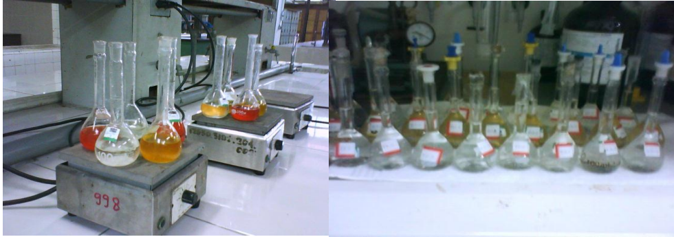
a) Preparación de muestras para la cuantificación de hierro para ser leídas en el Aparato Absorción Atómica
