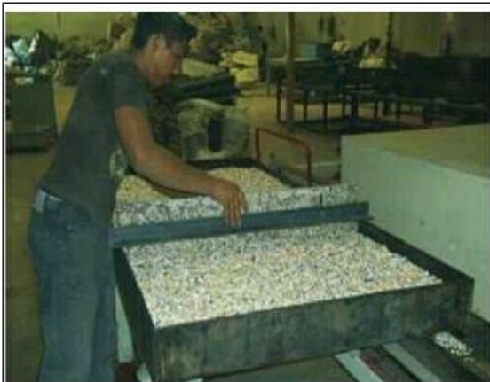
Figura 6: Proceso de formación de la plancha
