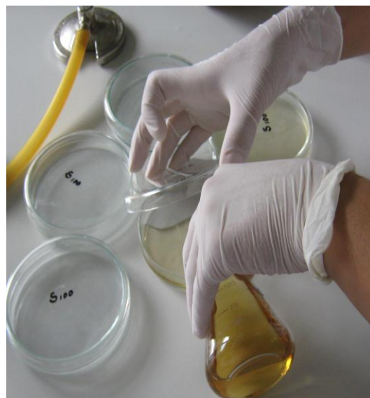
FIGURA Nº 31: Llenado de placa
