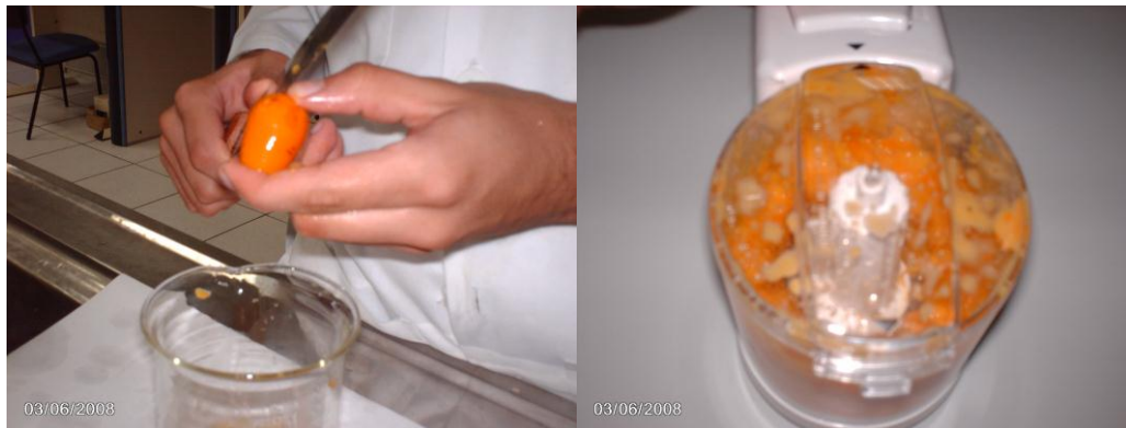
Figura Nº 25. Muestra partida en trozos o triturada para determinación de humedad y determinación de carotenoides totales, respectivamente.
