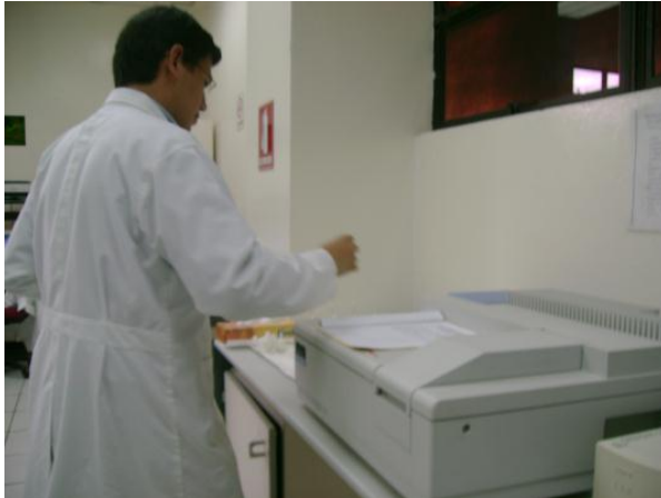
Figura N° 37. Calibrar espectrofotómetro con hexano como blanco.
