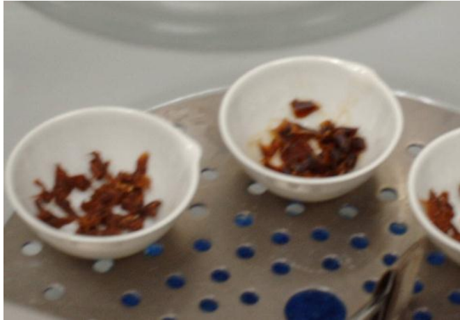
Figura N° 28. Sacar muestra del horno y dejar enfriar en desecador.
