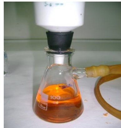
Figura N° 33. Filtrar la solución al vacío utilizando papel filtro whatman poro grueso
