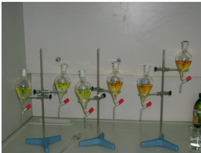
Figura N° 35. Transferir la solución a una ampolla de separación más 50 mL de hexano.
