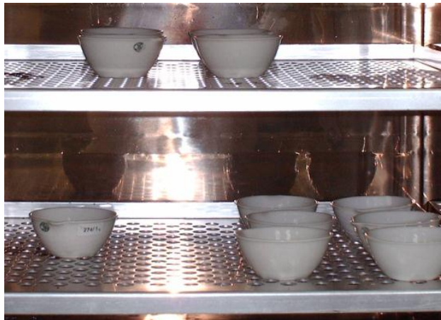
Figura N° 27. Secar muestra a 70 \pm 2^{\circ}\text{C} .
