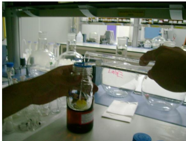
Figura N° 31. Adición de solvente para carotenoides a la muestra.
