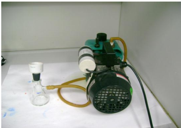
Figura N° 33. Filtrar la solución al vacío utilizando papel filtro whatman poro grueso
