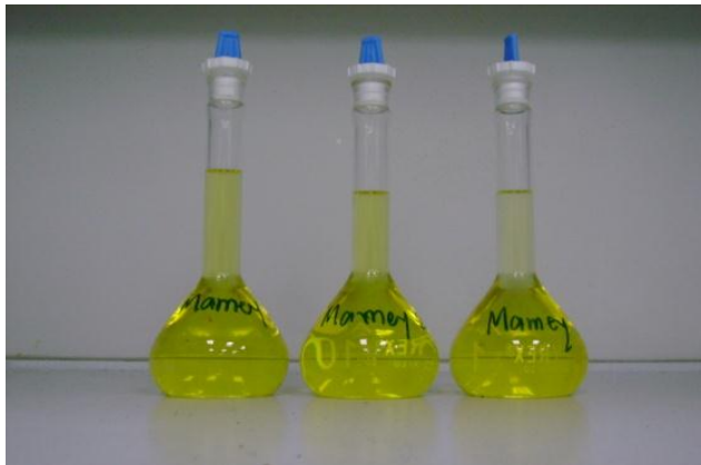
Figura N° 34. Transferir el filtrado a un balón volumétrico de 100 mL y aforar con solvente.
