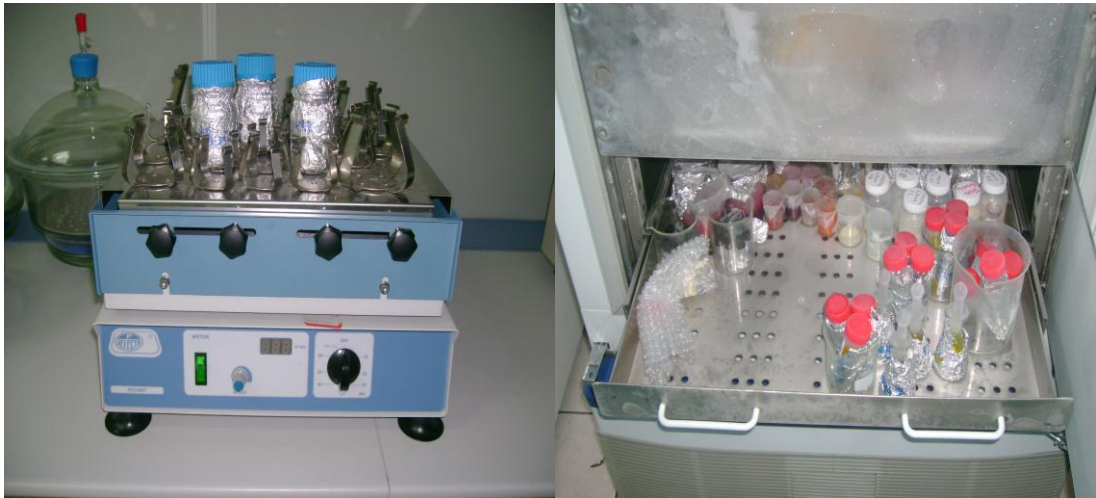
Figura N° 32. Homogenizar muestra con el solvente y dejar reposar por 24 horas a 4 \pm 2^\circ\text{C} .
