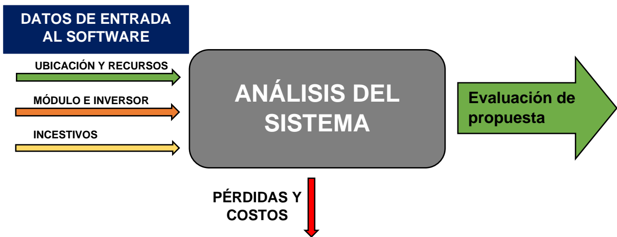
Figura 2.5. Caja negra de entradas y salidas para uso del software SAM. Fuente: SAM, 2020.
