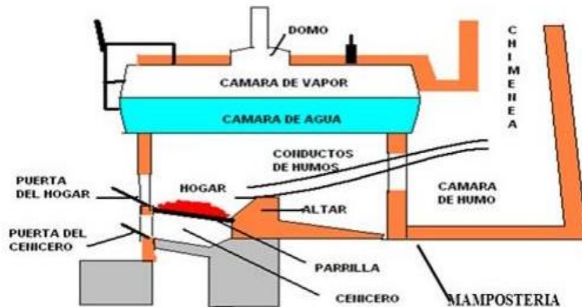
Figura 5.1. Componentes principales de una caldera.
