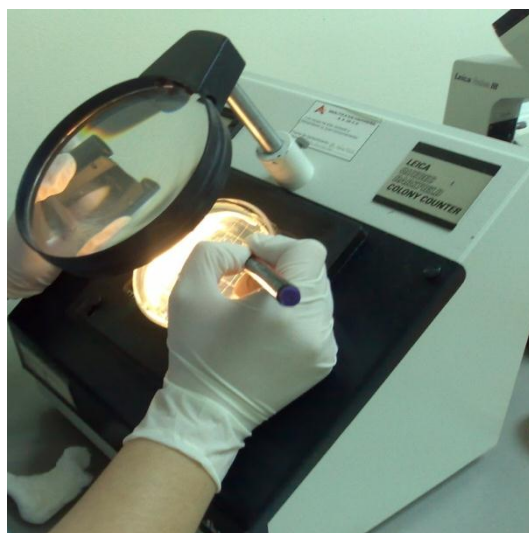
Figura N° 13: Análisis microbiológico (recuento y lectura de placas) a 25 \pm 2^{\circ}\text{C} y 75 \pm 5\% HR
