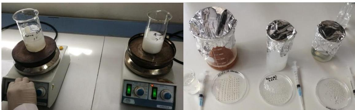
Figura N°10. Preparación de mezclas poliméricas de Goma Xantana: Gelatina (0.5:10%), Alginato de Sodio: Gelatina (3:10%) y Almidón de Maíz: Gelatina (3:10%) para realizar el proceso de encapsulación.
