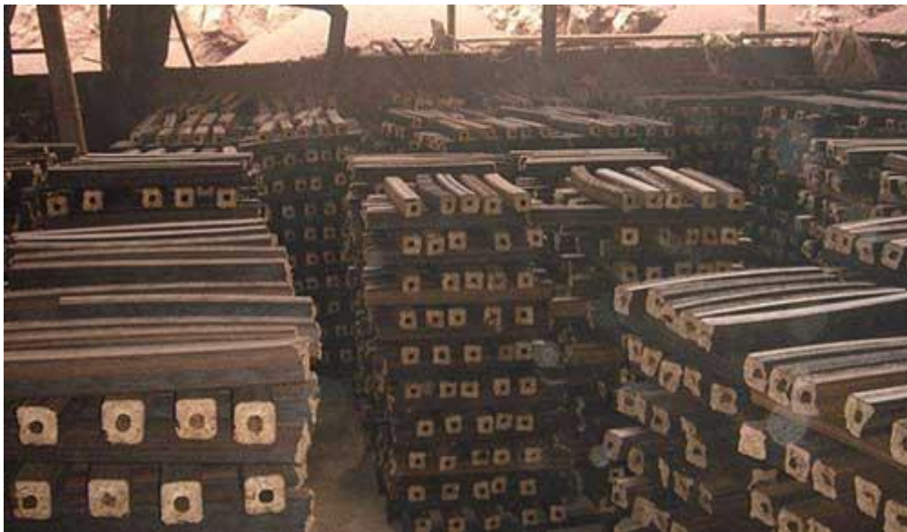
Figura 3-4. Almacenamiento de briquetas en pilas formando arreglos por los que puede fluir el aire, en un recinto bajo techo y despegadas del piso para evitar los efectos nocivos de la humedad. Fuente: briquettemachine.com.
