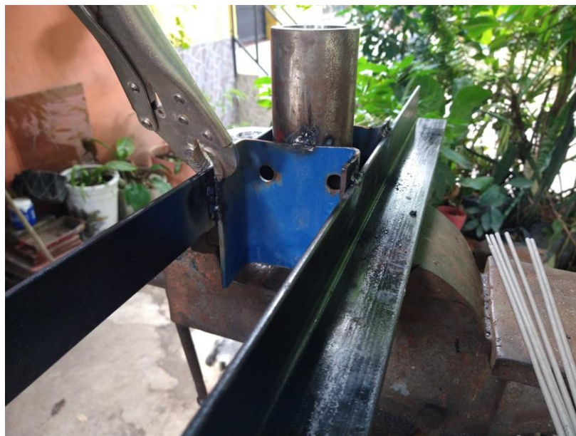
Figura 4-9. Fabricación de conjunto del molde para la máquina briquetadora. Fuente: fotografía tomada por los autores (El Salvador, septiembre 2021).
