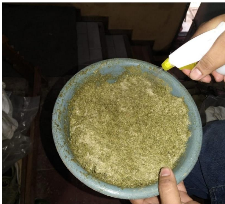
Figura 3-9. Mezclado de Eichhornia Crassipes con agua para mejorar su adherencia. Fuente: Fotografía tomada por los autores (El Salvador, 2021).
