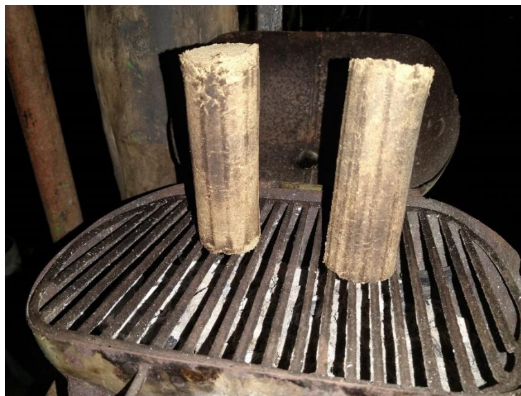
Figura 4-14. Briquetas de Jacinto de Agua fabricadas con el prototipo de briquetadora construido y puestas a secar en una estufa funcionando con las primeras briquetas fabricadas y que fueron rechazadas por no ser lo suficientemente resistentes. Fuente: Fotografía tomada por los autores (El salvador, 2021).
