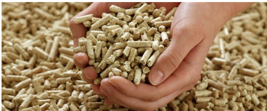
Figura 1-35. Pellets de biomasa, fabricados a partir de residuos vegetales. Fuente: guíadelacalefaccion.com.ar.
