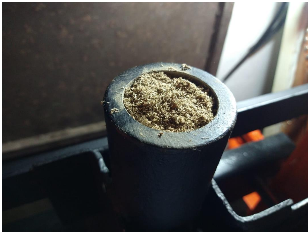
Figura 4-11. Llenado del molde con Jacinto de Agua molido. Este material fue comprimido usando únicamente las yemas de los dedos y se decidió no agregar más cuando alcanzó el borde superior. Fuente: Fotografía tomada por los autores.
