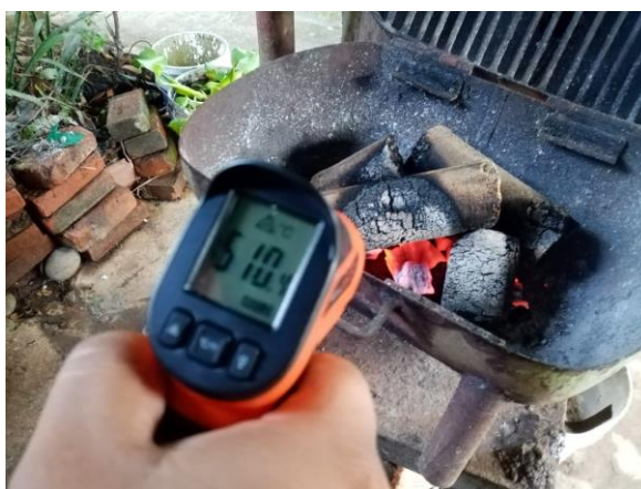
Figura 4-15. Ignición de briquetas de Jacinto de Agua utilizando carbón vegetal como iniciador del fuego. Una vez se alcanzó a formar una brasa en la briqueta, se removió el carbón y la combustión continuó hasta agotarse la materia combustible. Fuente: Fotografía tomada por los autores.
