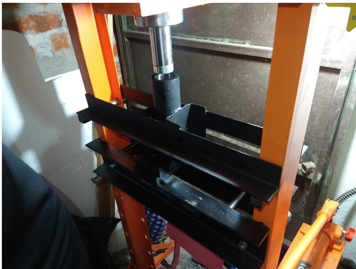
Figura 4-10. Prototipo de máquina briquetadora, realizado a partir de una prensa hidráulica. Fuente: Fotografía tomada por los autores.
