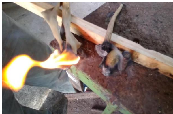
Figura 4-16. Combustión del Jacinto de Agua únicamente secado. A diferencia del Jacinto de Agua densificado, así si se desprenden llamas, sin embargo, se consume muy velozmente la materia. Fuente: Fotografía tomada por los autores (El Salvador, 2021).
