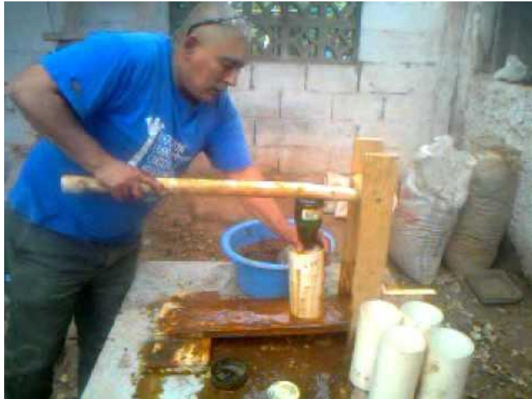
Figura 2-5. Briquetadora manual. La compactación ocurre por la aplicación de una fuerza procedente del usuario, para lo cual se aplica el concepto de ventaja mecánica empleando una palanca. Fuente: Capilladelmonte2.wordpress.com
