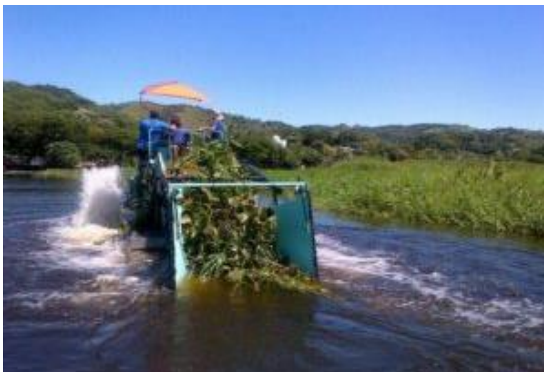
Figura 1-15. Barcaza recolectora de Jacinto de Agua propiedad del MARN, trabajando en el embalse Cerrón Grande en la jurisdicción del municipio de Suchitoto. Esta ha sido bautizada como “Jacinta”, dada la naturaleza de sus funciones.
