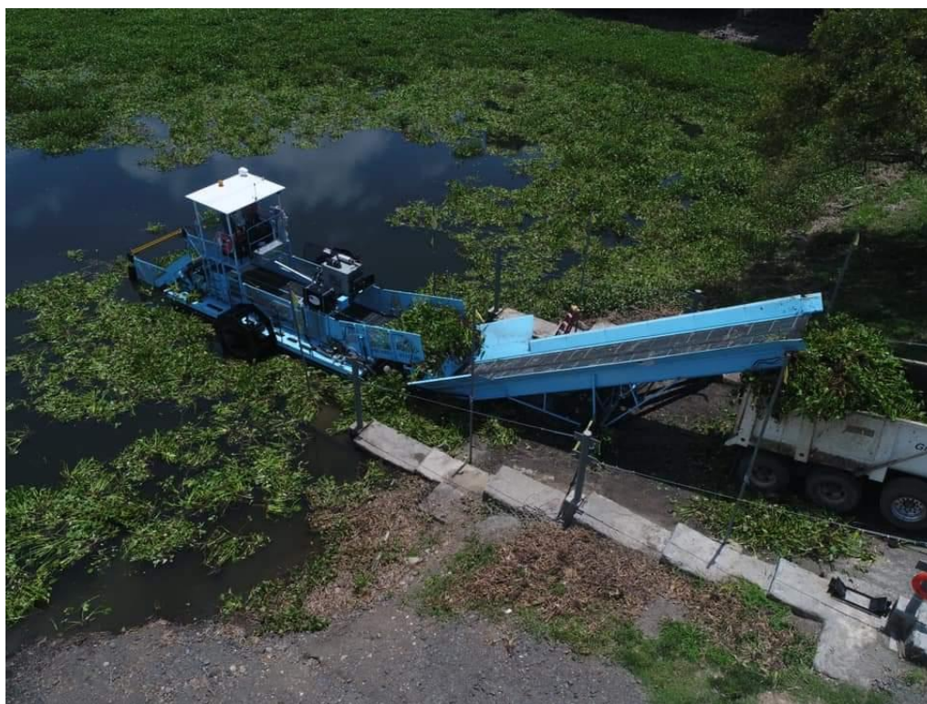
Figura 3-1. Uso de una barcaza cosechadora en conjunto con una banda transportadora para cargar directamente un camión de volteo con Jacinto de Agua y otras malezas acuáticas en la central hidroeléctrica “5 de noviembre”. Fuente: Perfil oficial de Facebook de la Comisión Ejecutiva Hidroeléctrica del Río Lempa.
