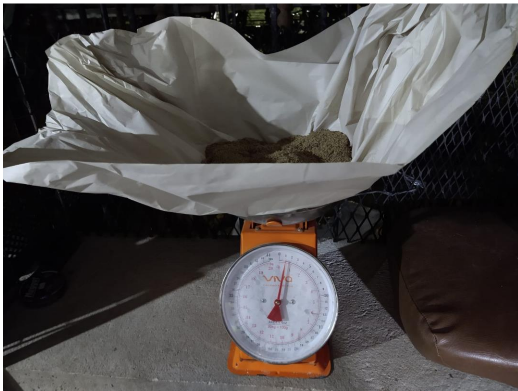
Figura 4-12. Medición del peso de la materia prima restante, determinándose que se requieren 0.25 libras de Jacinto de Agua molido finamente para fabricar una briqueta. Fuente: Fotografía tomada por los autores.
