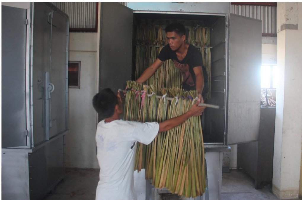
Figura 2-9. Utilización de secadores solares para remover la humedad de los tallos del Jacinto de Agua en Filipinas. Este proceso tomaría normalmente una semana si se expusieran los tallos frescos al Sol, pero con este dispositivo, ese tiempo se reduce a tan solo una hora. Fuente: Department of Science and Technology – Science and Technology Information Institute.
