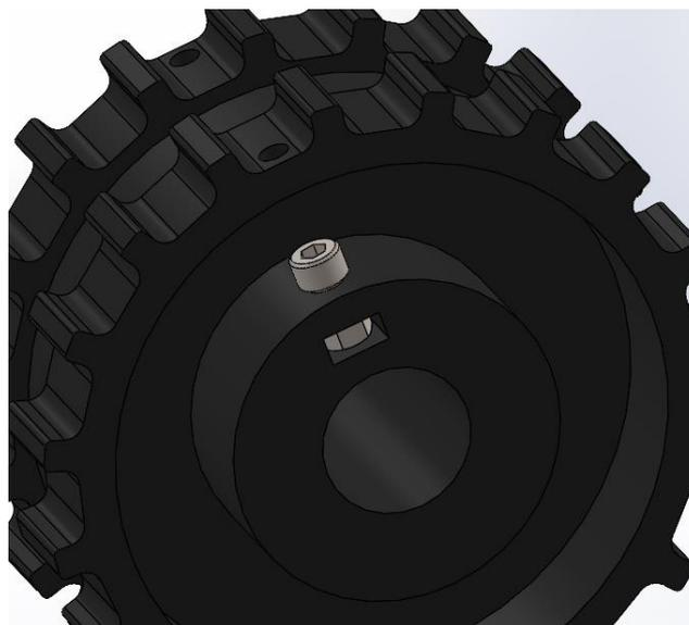
Fig. B29. Perno de fijación del piñón.
