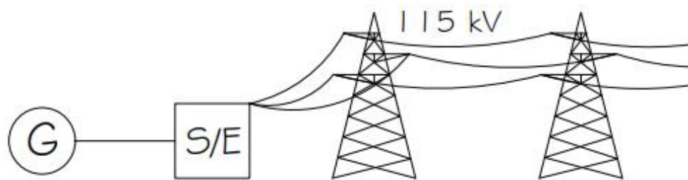
Generador Subestación Líneas de Transmisión
