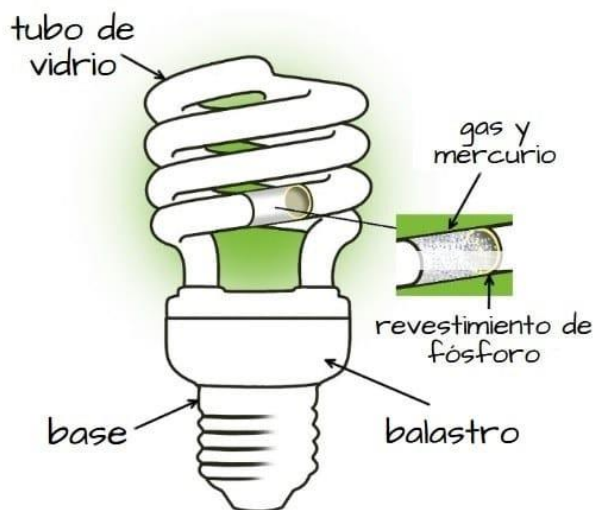
Ilustración 5 Lámparas fluorescentes compactas y sus partes.
