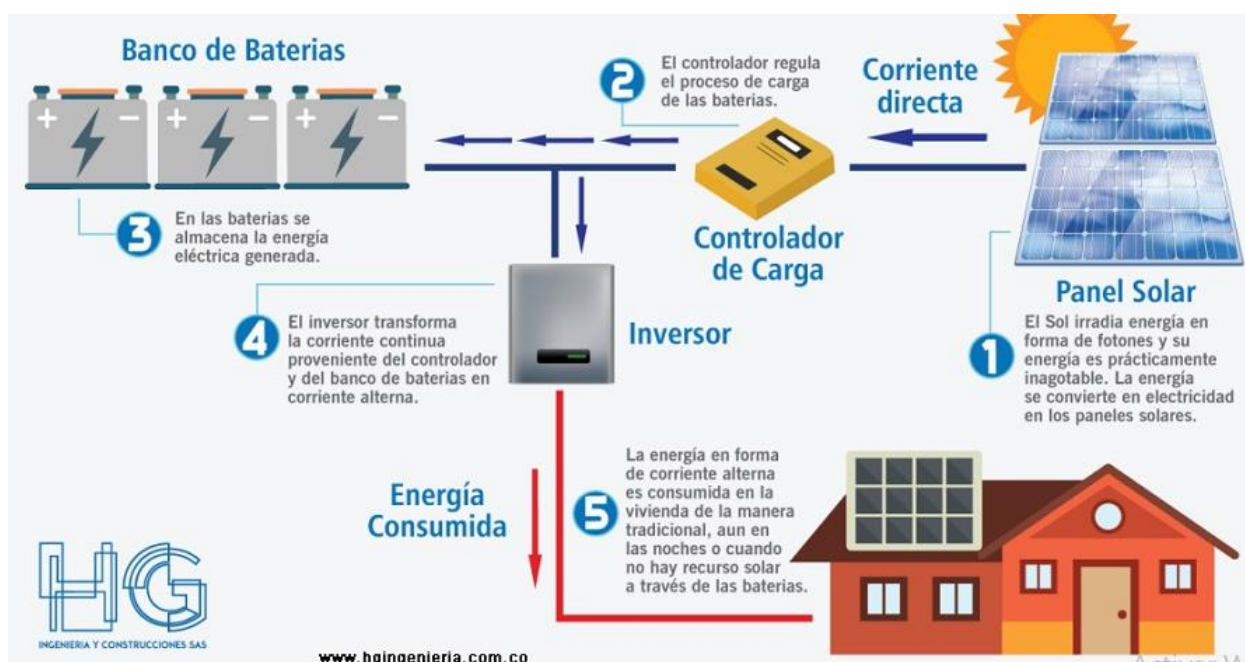
Figura 28 Sistema fotovoltaico
