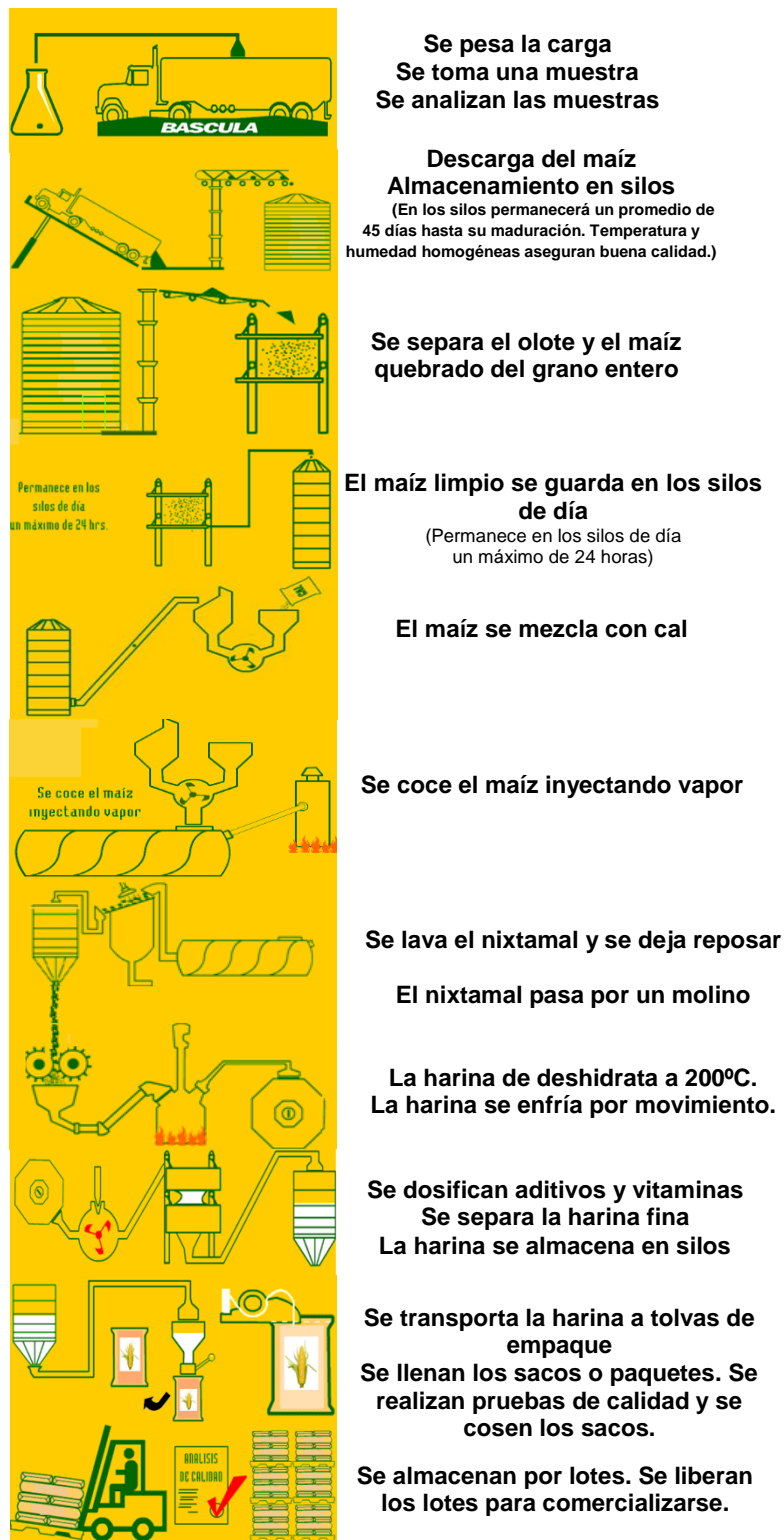
Figura N°6. Proceso industrial de la elaboración de harina de maíz nixtamalizado fortificada (28)
