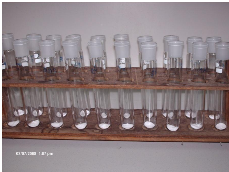
Figura N°20. Preparar tubos con 1.5 g de NaCl para saturar la fase acuosa de la mezcla por preparar
