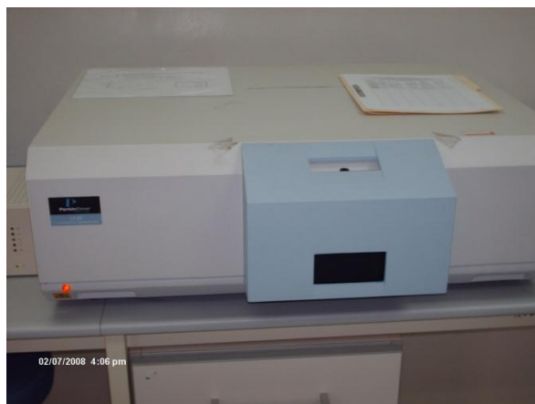
Figura N°27. Equipo para Espectrómetro de luminiscencia Perkin Elmer® modelo LS – 55
