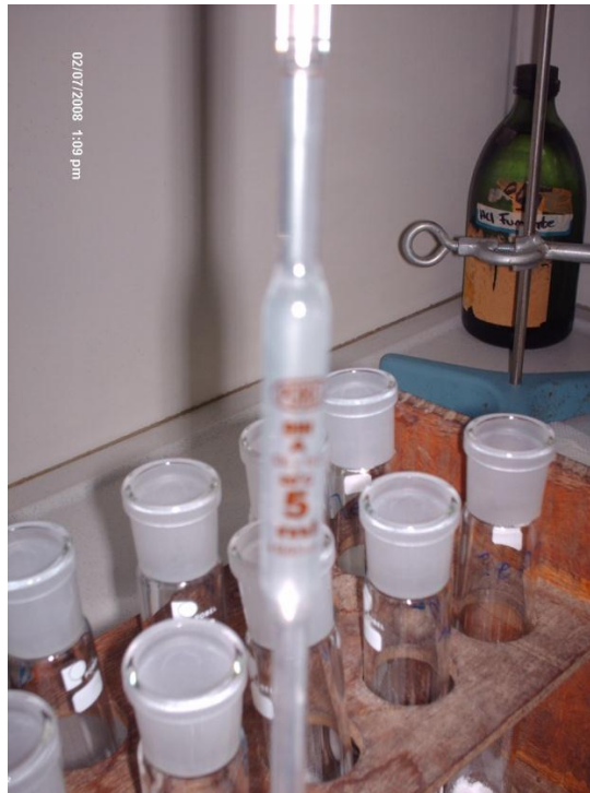
Figura N°21. Pipetear 5,0 mL del filtrado transparente de la solución de muestra de HMNF
