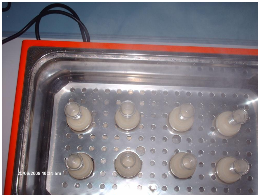
Figura N°12. Durante la digestión agitar ocasionalmente las soluciones:
