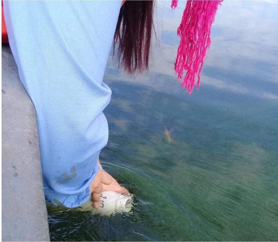
Figura A. 6 Toma de muestra de agua para análisis de fosfatos, DBO5 y Coliformes
