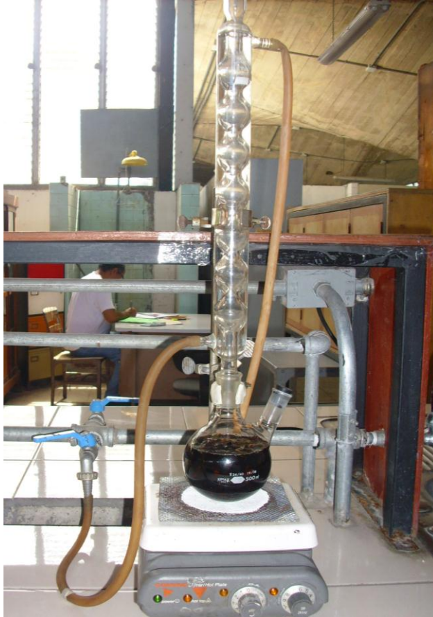
Figura N° 34. Extracción del colorante con NaOH 0.5 N
