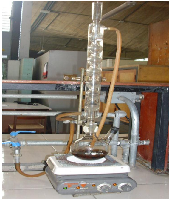
Figura N° 36. Extracción del colorante con Etanol 70%
