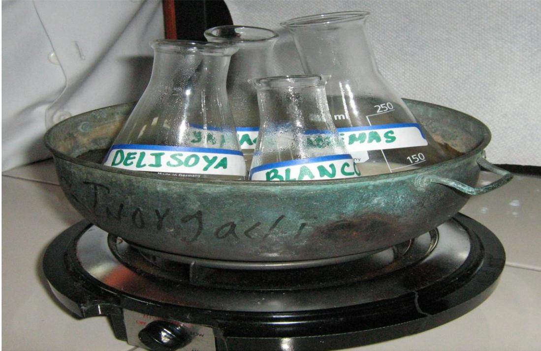
Figura N° 15. Baño maria para prueba de vitamina A.
