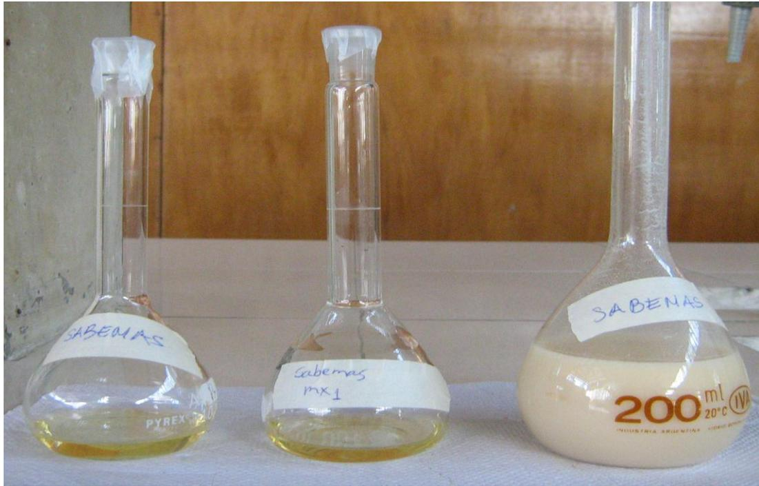
Figura N° 19. Muestras listas para leer Calcio y Zinc en espectrofotómetro de absorción atómica.
