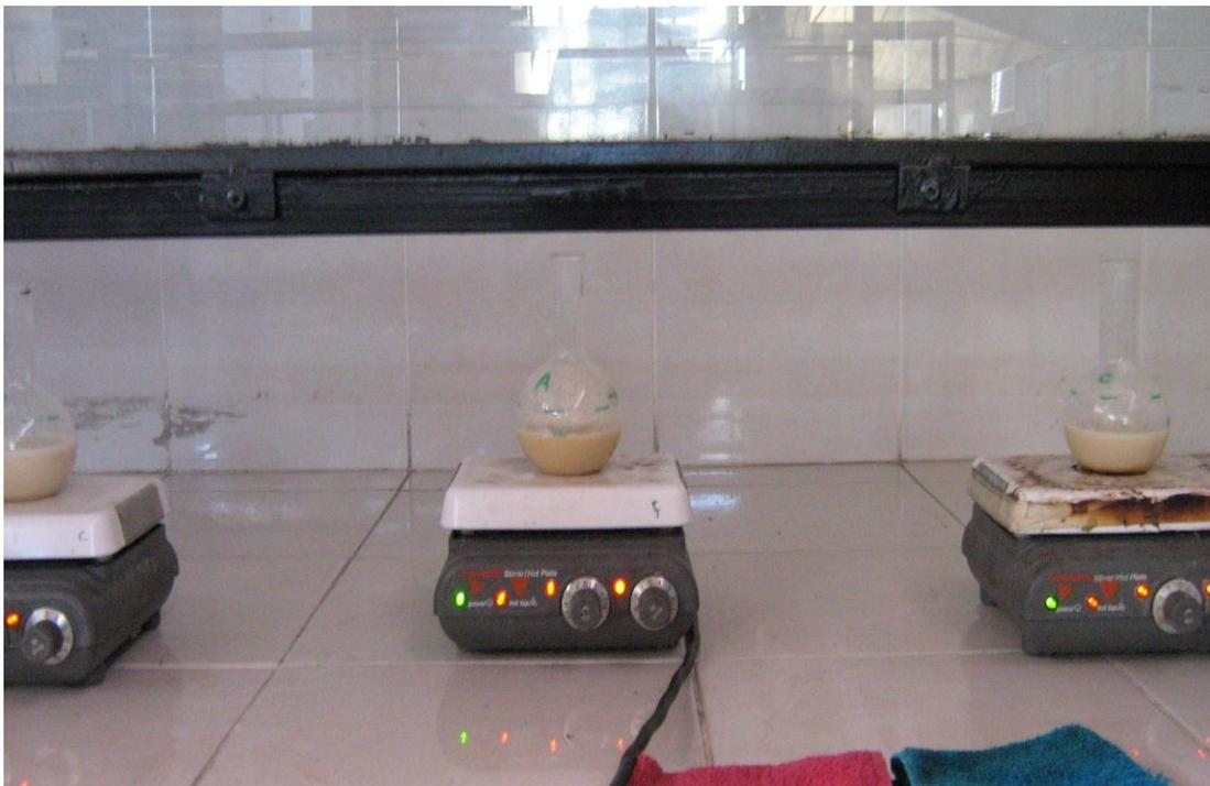
Figura. N° 18. Digestión de muestras de leches de soja en polvo para análisis de Calcio y Zinc.
