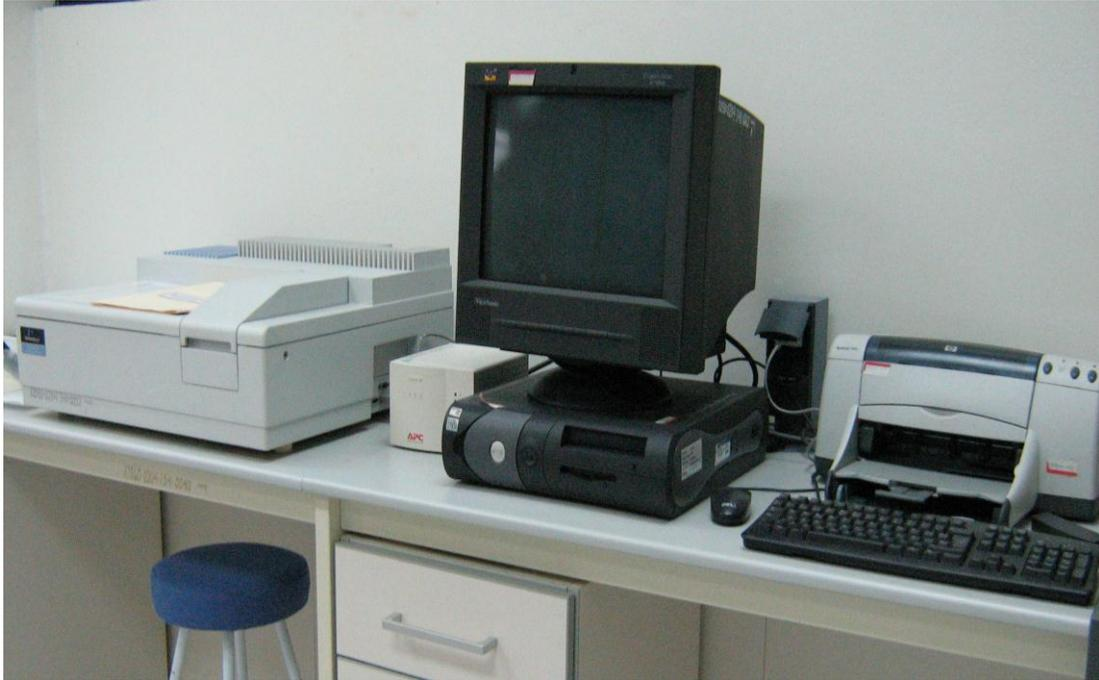
Figura N° 17. Espectrofotómetro UV-VIS.
