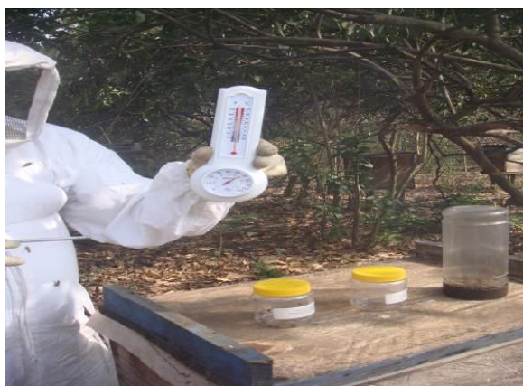
Figura 11. Termómetro para temperatura y humedad relativa.
