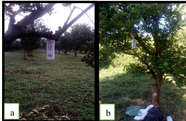
Figura 8. Medición de temperatura y humedad relativa. a. Altura del higrometro, b. medición de T° y %HR
