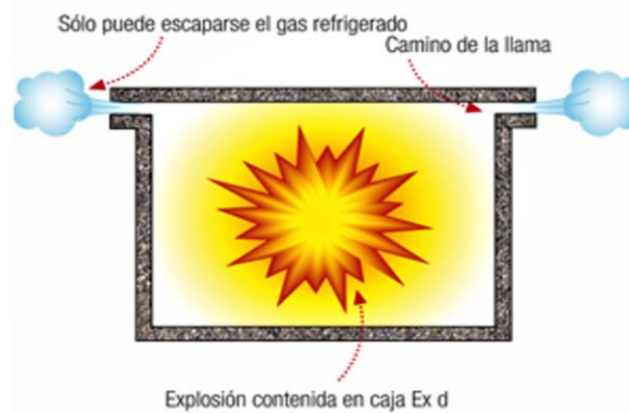
Figura 7-4. Diseño de aparato anti- deflagración.
