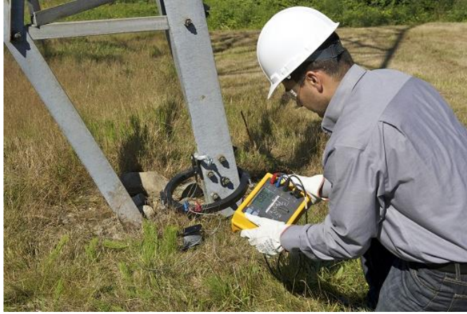
Figura 6- 23. Medición de puesta a tierra con un telurómetro de la marca FLUKE. Tomado de: (Fluke Corporation , 2021).
