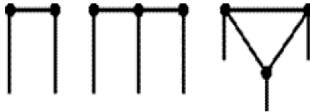
Figura 6-27. Arreglos de 2 o 3 electrodos para sistemas de puesta a tierra.
