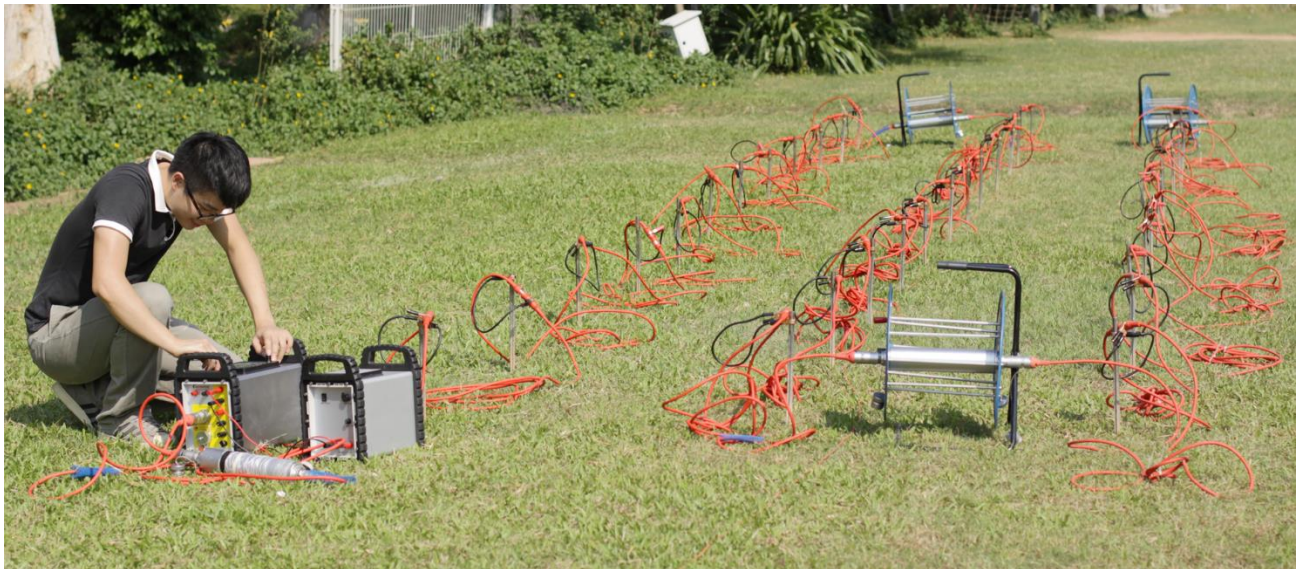
Figura 6- 10. Medición de la resistividad eléctrica del suelo mediante el Tomografía eléctrica. Tomada de: cartomex.com.
