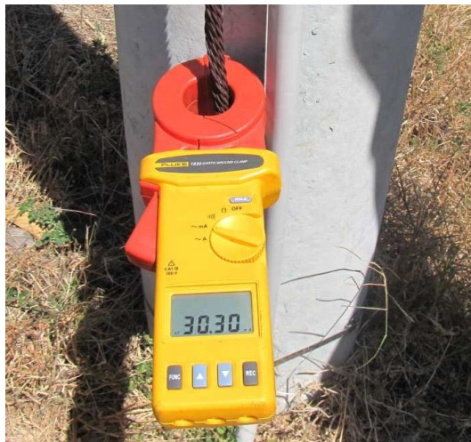
Figura 6- 21. Telurómetro tipo pinza de la marca FLUKE. Tomado de: (Telurómetro , 2021).
