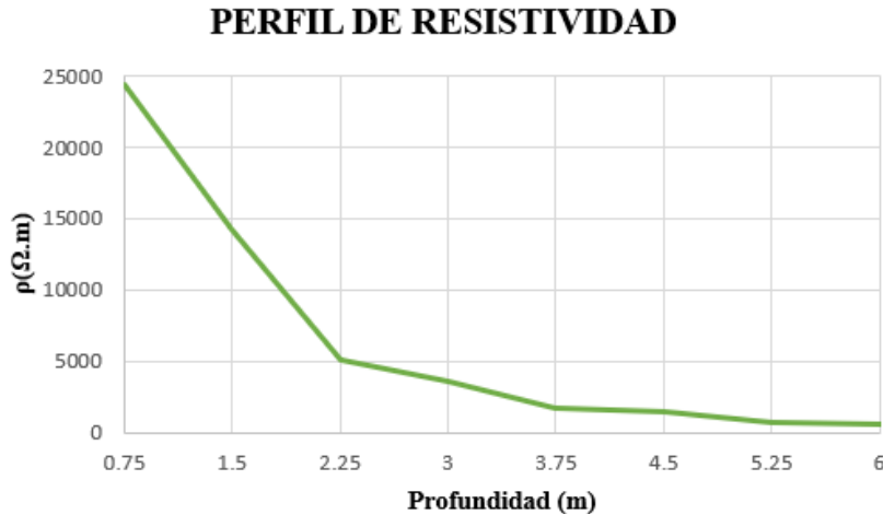
Figura 6-6. Perfil de resistividad obtenido mediante la aplicación del método de Wenner.
