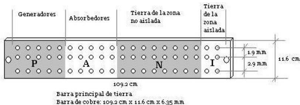
Figura 6- 60. Barra principal de tierra.
