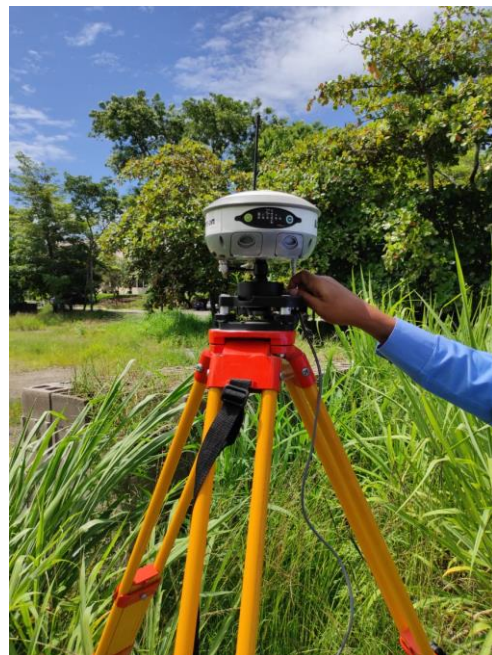
Figura 3.53: Colocado de cable de alimentación al equipo. Fuente: (Ramírez 2021).
