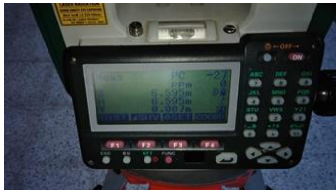
Figura 3.7: Calibración de constante de prisma. Fuente: (Ramírez 2021).
