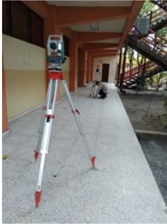
Figura 3.6: Calibración de constante de prisma en Estación Total. Fuente: (Ramírez 2021).
