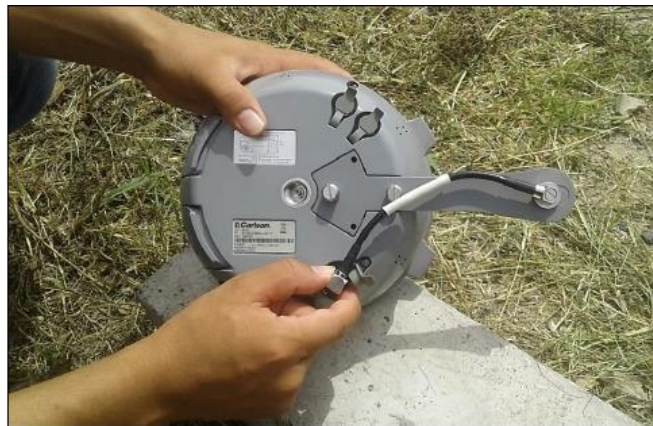
Figura 3.50: Enroscado de cable de antena a equipo. Fuente: (Ramírez 2021).
