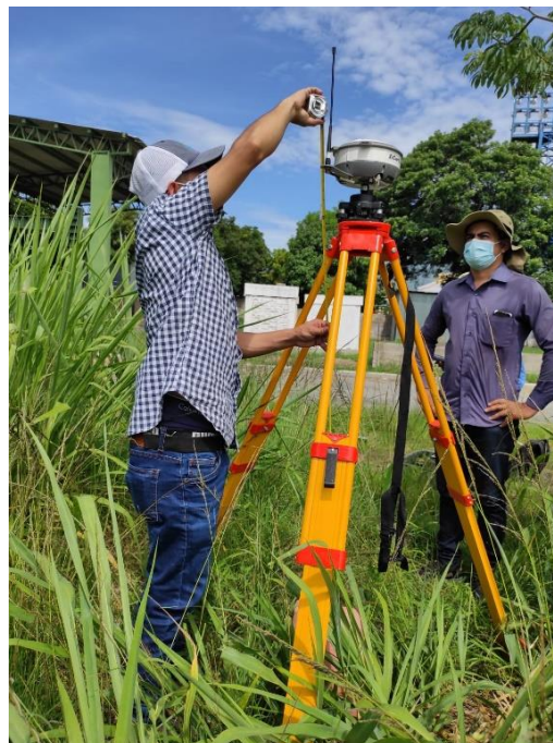
Figura 3.65: Medición de altura de antena. Fuente: (Grupo de Tesis, 2021).
