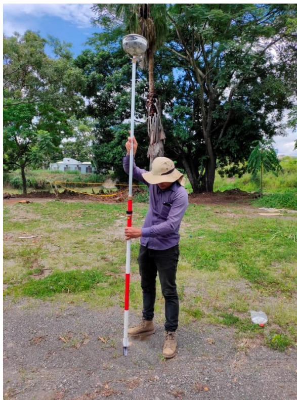
Figura 3.54: Rover armado en bastón con burbuja. Fuente: (Grupo de Tesis, 2021).
