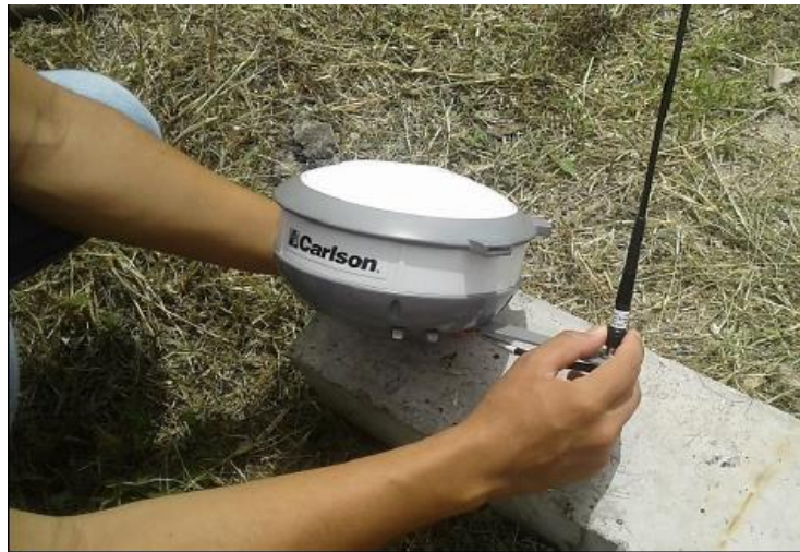
Figura 3.51: Enroscado de antena a dispositivo. Fuente: (Ramírez 2021).
