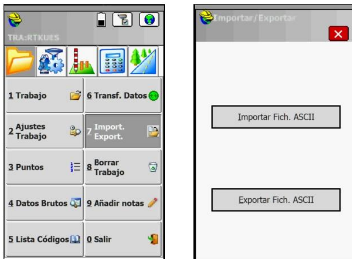
Figura 3.72: Sección 7 y exportación de fichero levantado. Fuente: (Ramírez 2021).
