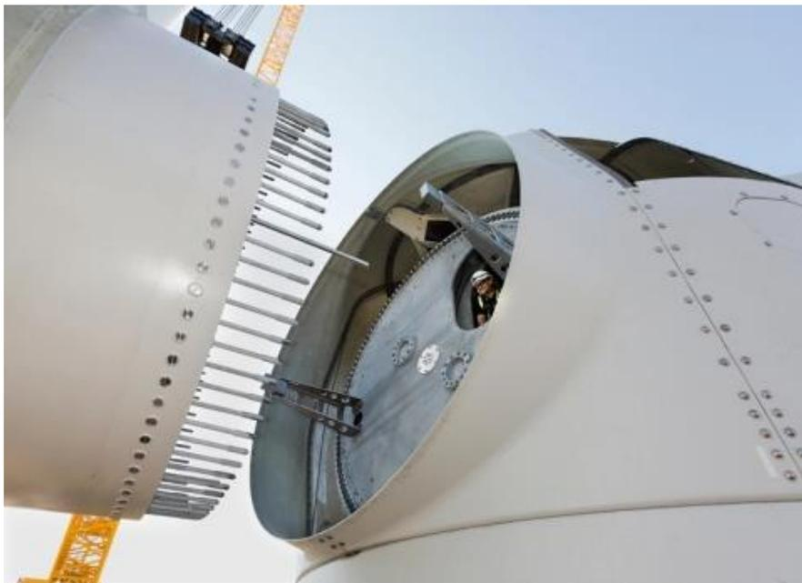
Ilustración 1.13 Buje de una turbina eólica.
