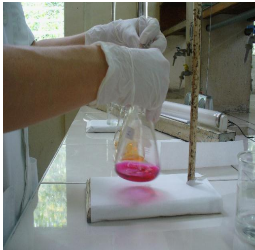
Figura No. 4 Titulación usando anaranjado de xilenol como indicador en determinación de Bismuto
