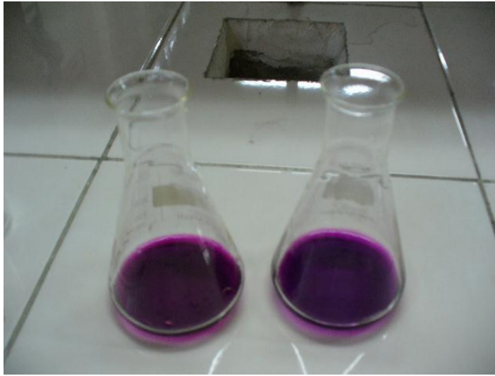
Figura No 17 Viraje de color de amarillo a violeta. Determinación de Níquel, utilizando como indicador murexide
