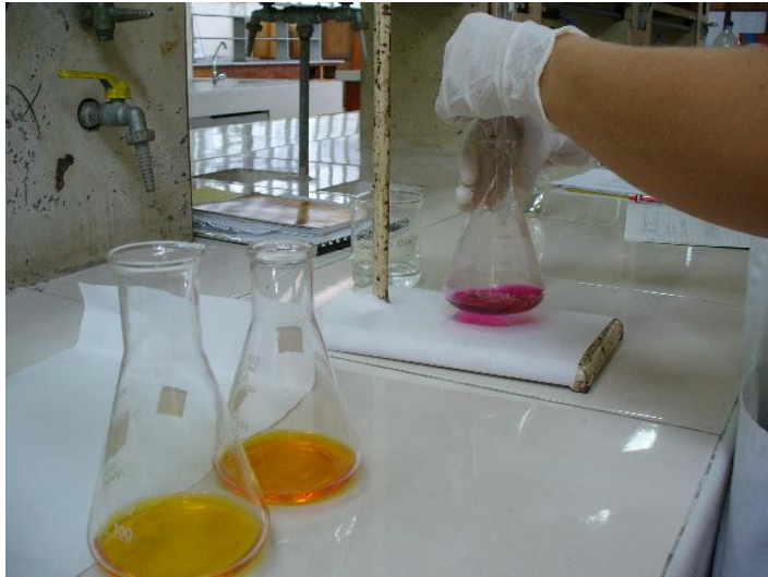
Figura No 5 Viraje de color de rojo a amarillo luminoso en Determinación de Bismuto
