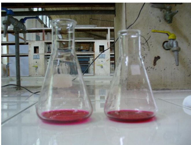
Figura No 13 Indicador utilizado Negro de Eriocromo T (NET), viraje de color de Azul a rojo vino, en la Determinación de Sulfatos
