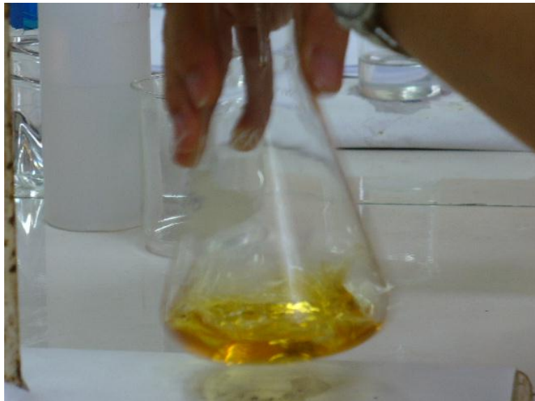
Figura No 10 Indicador en la Determinación de Hierro utilizado anaranjado de xilenol
