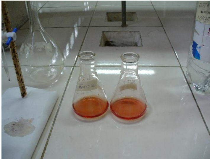
Figura No 11 Viraje de color de amarillo a rojo cereza en la determinación de Hierro
