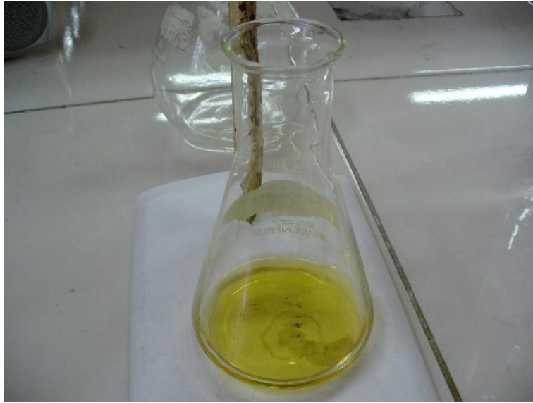
Figura No 9 Determinación de Hierro mediante una Retrovaloración con Nitrato de Torio 0.1M
