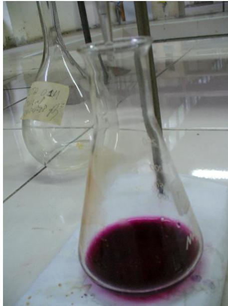
Figura No 15 Cambio de color de naranja a violeta. Determinación de Cobre, utilizando como indicador Murexide.
