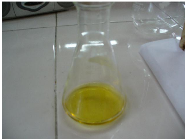
Figura No 16 Determinación de Níquel, utilizando como valorante EDTA 0.1M y murexide como indicador
