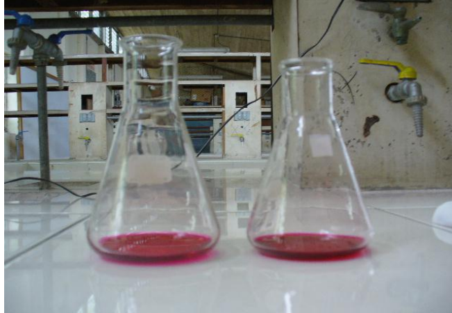
Figura No.3 Determinación de Bismuto utilizando EDTA 0.1M como solución valorante
