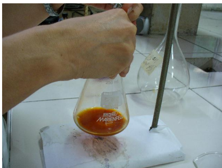
Figura No 14 Determinación de Cobre, utilizando EDTA 0.1M como solución valorante y murexide como indicador
