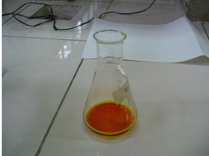
Figura No 6 Determinación de Calcio. Titulación con solución de EDTA 0.1M
