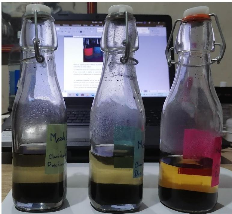
**Figura 4.9.** Tercera prueba de filtrado, de derecha a izquierda dosificación de 4.67, 7 y 9.33 gramos respectivamente.
