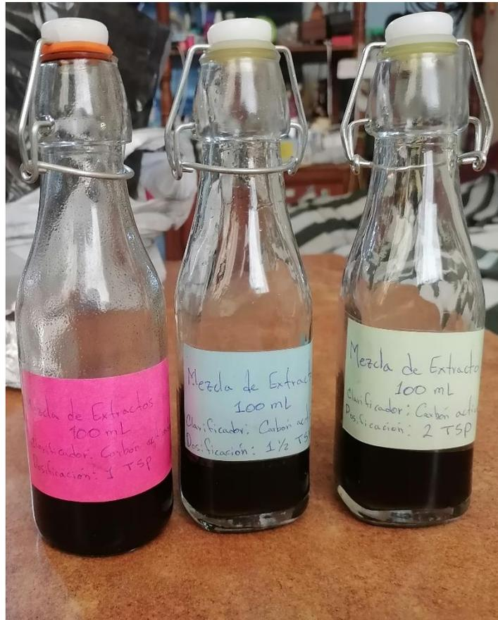
**Figura 4.8.** Segunda prueba de filtrado, de izquierda a derecha dosificación de 2.33, 3.5 y 4.67 gramos de carbón activado.
