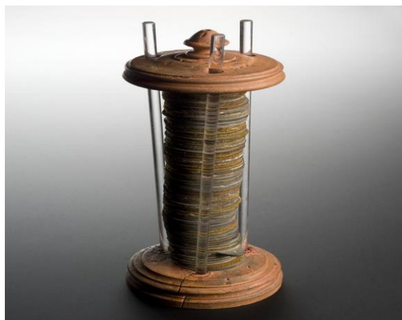
Figura 2: Primeras baterías o pilas que se diseñaron, consistían en discos alternos de zinc y cobre separados por papel o tela empapados en salmuera [2].
