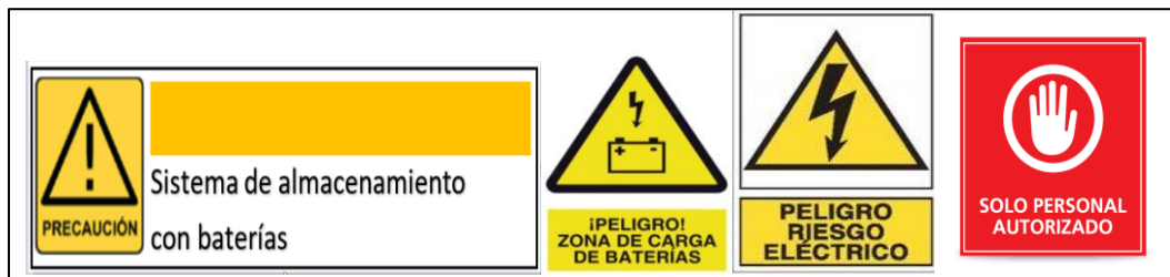
Figura 58: Señalizaciones de seguridad en un SAEB.
