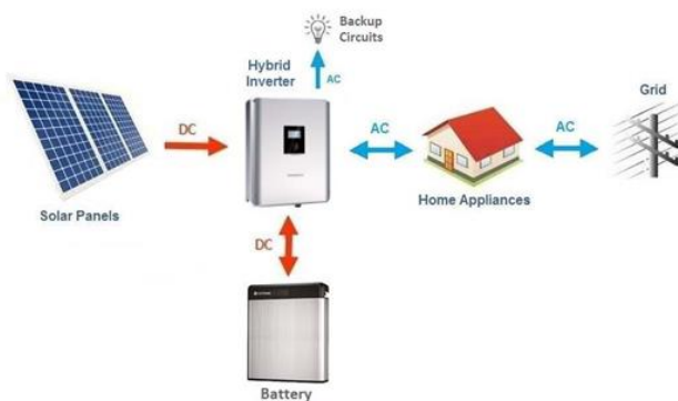
Figura 23: Diagrama básico de un sistema solar con un inversor híbrido para energía de respaldo.
