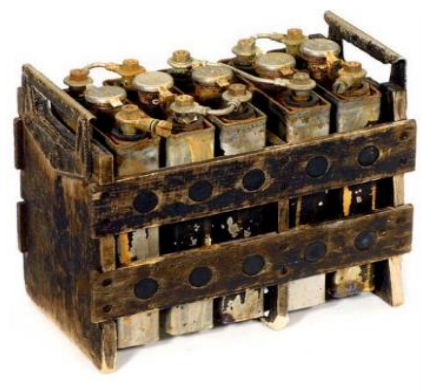
Figura 4: Batería hierro- níquel, con una carga nominal por celda de 1.2V, eficiencia carga/descarga entre 65%y 85% [5].
