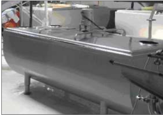
Figura 1.6: Tanques refrigerados para almacenamiento temporal del jugo.
