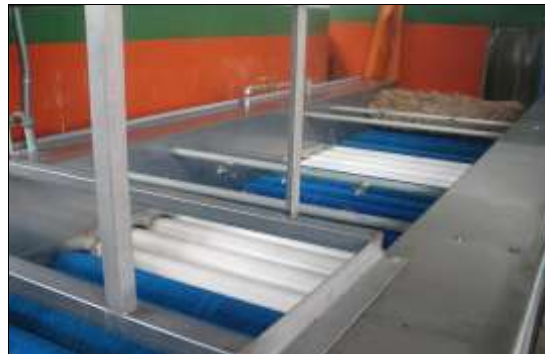
Figura 1.3: Máquina lavadora de cítricos
