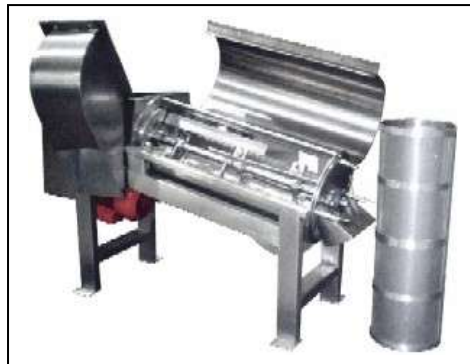
Figura 1.7: Despulpadora para jugo de naranja y limón
