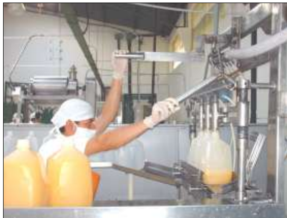
Figura 1.8: Proceso de envasado del jugo.
