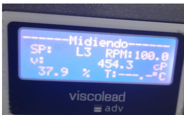
Figura 3.21: Medición de viscosidad de gel de ducha.
