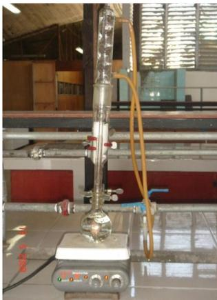
**Figura N° 9:** Aparato de Soxhlet.
