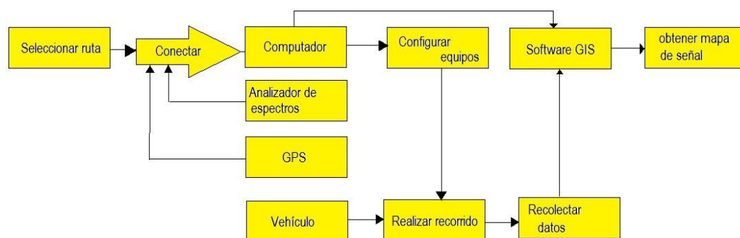
Ilustración 34: Diagrama de bloques que muestra el proceso de medición de Drive Test
