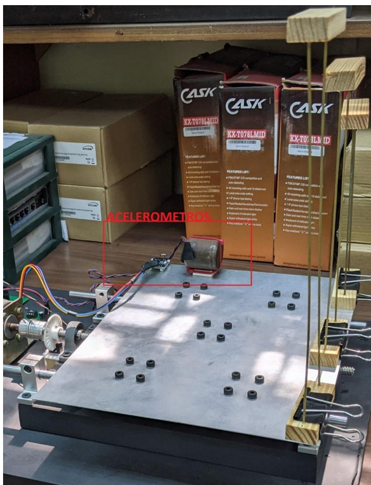
FIGURA 20 Acelerómetros en el simulador. [Elaboración propia]
