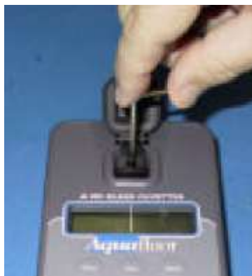
Foto 3: Ajustando el valor del estándar secundario mediante el giro del tornillo de atenuación.
