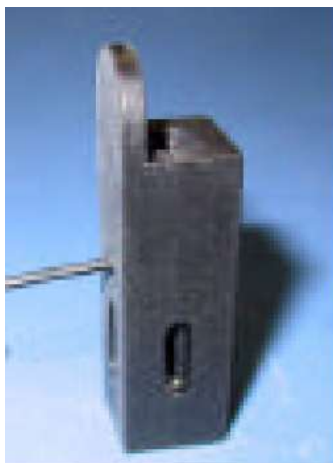
Foto 1: aflojando el tornillo tracero del estándar secundario para su ajuste.
