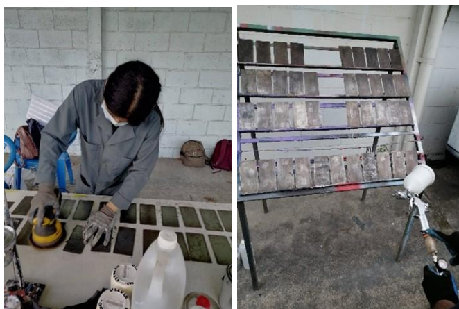
Figura 3.9. Preparación de Superficie y aplicación de recubrimiento epóxico en especímenes en evaluación.
