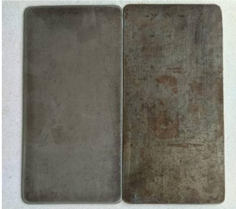
Figura 3.3 Comparacion de Especimen Natural y otro con limpieza manual + Abrasivo 180.
