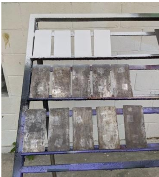
Figura 3.7 Comparación de especímenes con recubrimiento aplicado y especímenes preparados.
