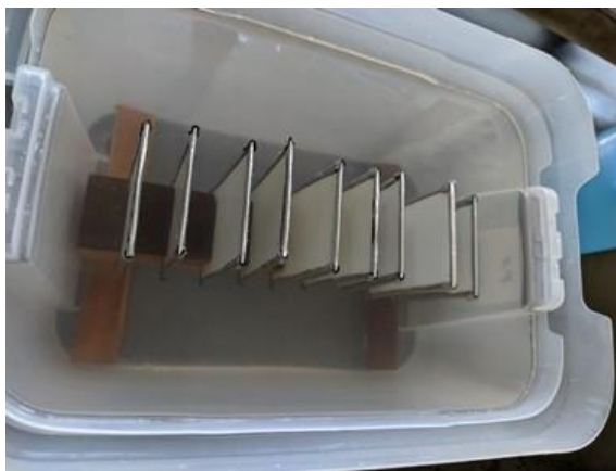
Figura 3.8. Cámara Salina construida
