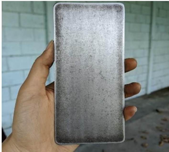
Figura 3.4 Espécimen con limpieza manual + abrasivo 180 + abrasivo 240.
