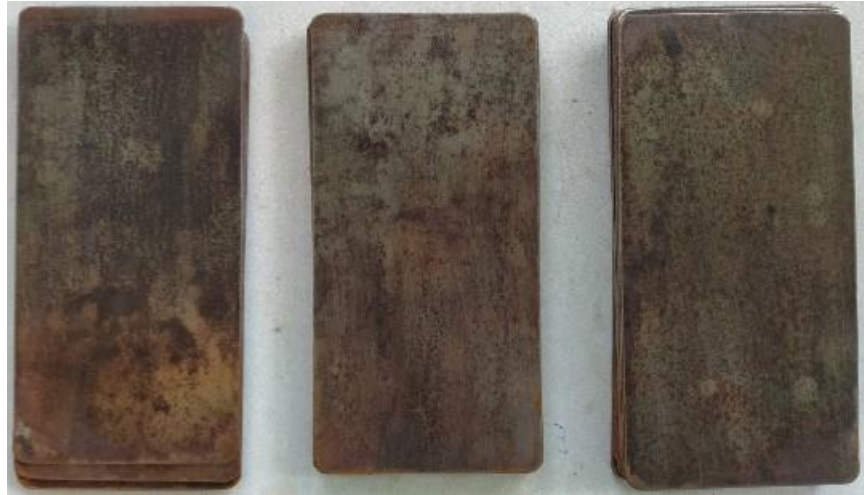
Figura 3.1 Muestras Originales de Hierro Dulce, especímenes de Prueba.
