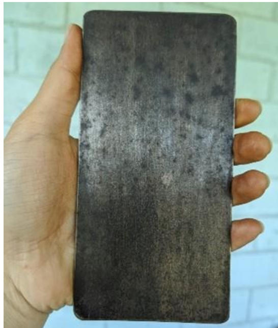
Figura 3.2. Especímen de acero A36 después de la limpieza manual (pañuelo+Jabon+Agua).
