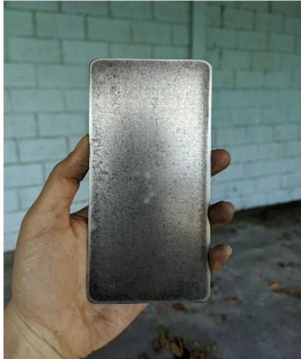
Figura 3.5 Espécimen con limpieza manual + abrasivo 180 + abrasivo 240 + Wipe con nafta desengrasante.
