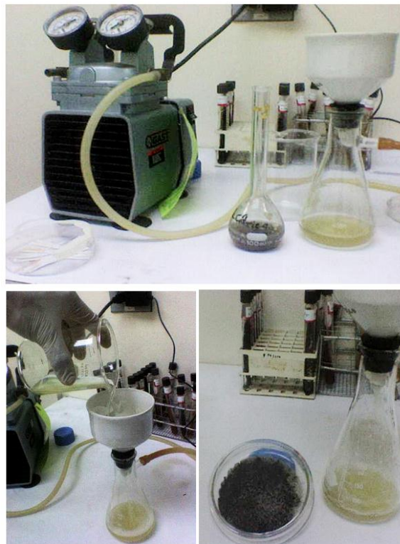
Fig N° 39: Proceso de Obtención de Biomasa (filtración al vacío)
