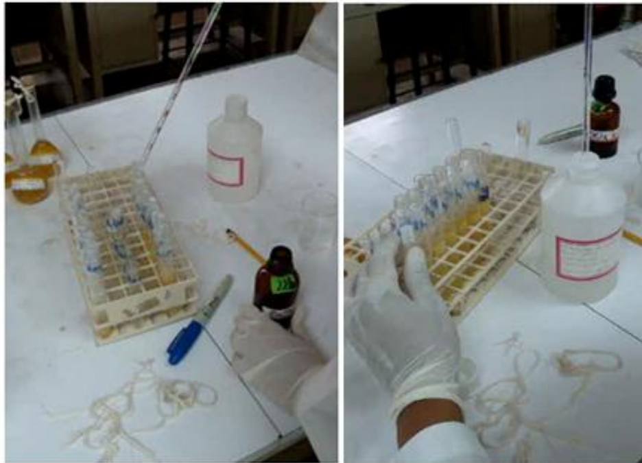
Fig. 41: Adición de ZnSO_4 y NaOH 0.5 M
