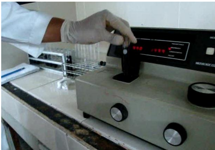
Fig. 47: Lectura de Absorbancias en Spectronic 20
