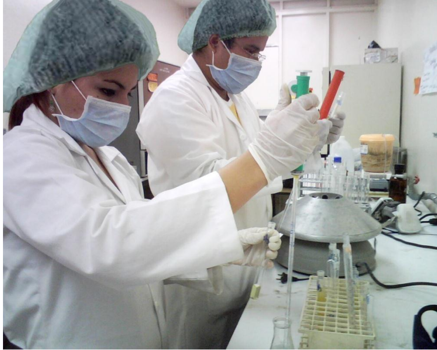
Fig. 40: Toma de Mx de Filtrado para determinación de azúcares totales
