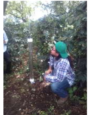
Foto 5. Introduciendo el reservorio Inferior dentro del reservorio exterior.
