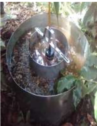
Foto 2. Agua del anillo interior y exterior a un nivel similar
