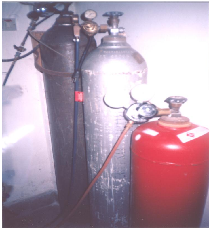
Figura N° 3: Gas de arrastre (ARGÓN)
