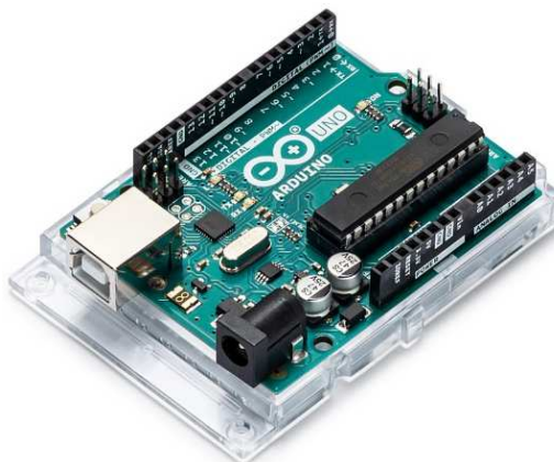
Fig. 1.13. Arduino UNO R3.
