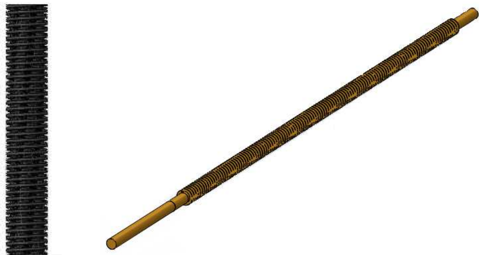
Fig. 3.8. Especificaciones para el cálculo de costos de los tornillos de potencia: a) Tornillo vertical \varnothing 3/4 pulg, paso 1/6 pulg, altura de filete 1/12 pulg, ángulo de ataque \alpha = 14.5^\circ , longitud roscada de 25 cm y Rosca ACME; b) tornillo horizontal, paso 1/5 pulg, altura de filete 1/10 pulg, ángulo de ataque \alpha = 14.5^\circ , longitud roscada de 72.77 cm y Rosca ACME.
