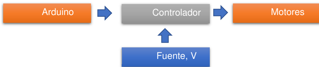
Fig. 2.29. Diagrama de bloque del sistema de control de velocidad.
