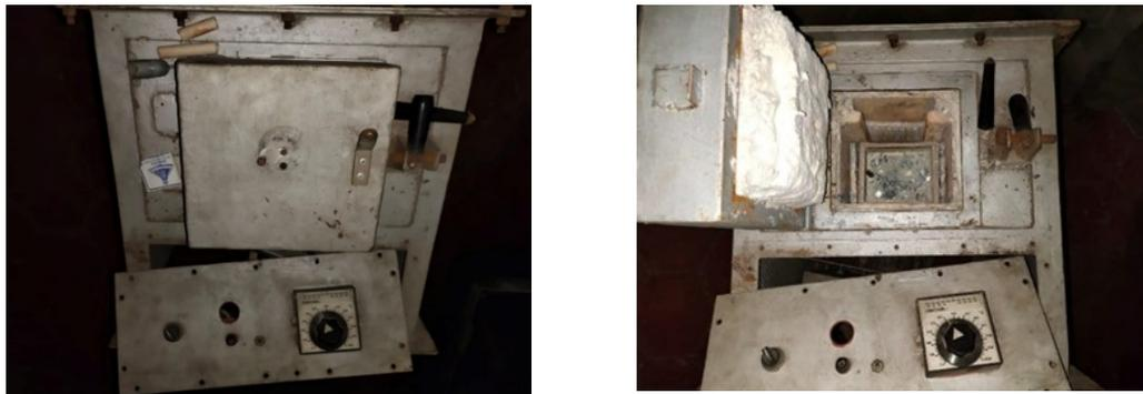
Fig. 2.2. Horno eléctrico que se utilizará para su reconversión a fragua a gas propano [21].
