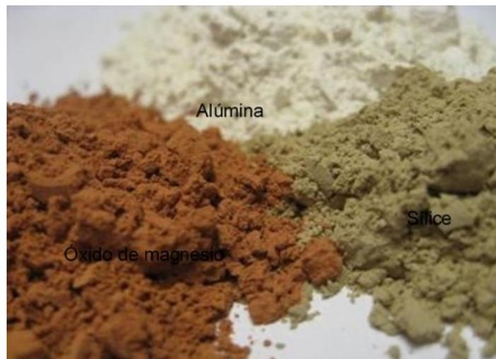
Fig. 1.8. Tipos de arcilla para fabricación de material refractario [8].
