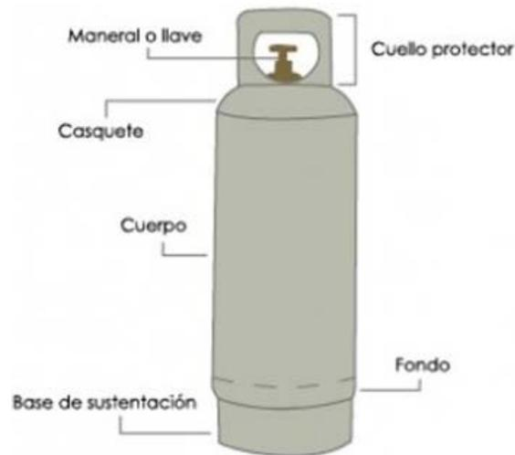
Fig. 1.13. Partes de un cilindro de gas [11].
