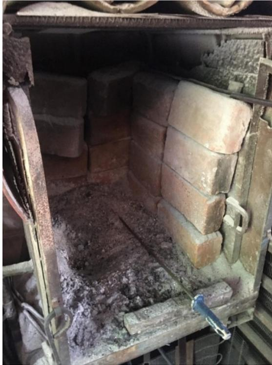
Fig. 1.2. Cámara de combustión de una fragua artesanal a carbón.
