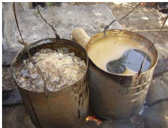
Brea con la cual bañan la fibra de mezcal.
