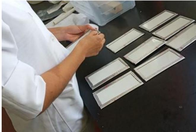
**Figura 3.9 Colocación de cinta tapa goteras a los bordes de las láminas**
