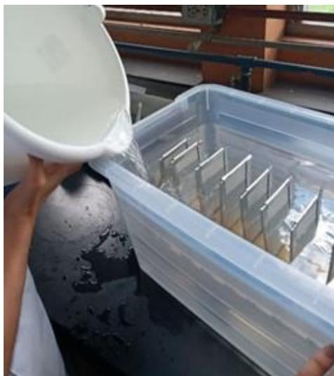
**Figura 3.12** Llenado de la caja plástica con la solución salina al 5% m/v.
