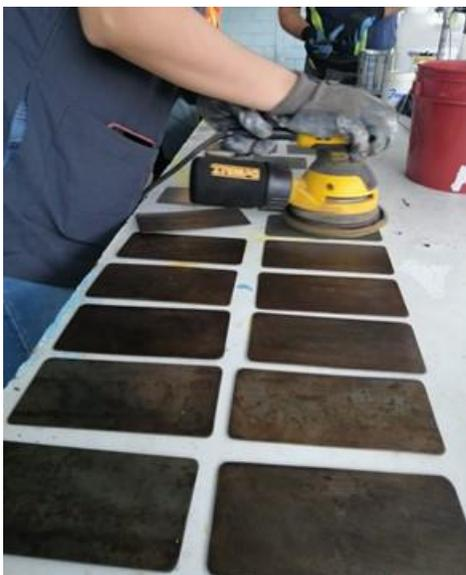
**Figura 3.2** Proceso de lijado de láminas con grano de lija 180.
