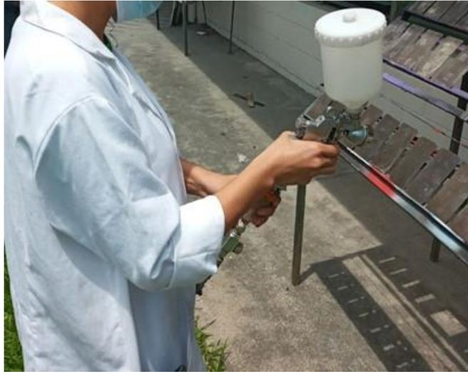
**Figura 3.8 Aplicación de muestras de pinturas por medio de pistola.**
