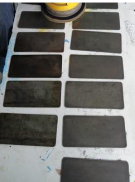
**Figura 3.3.** Proceso de lijado de láminas con grano de lija 240.
