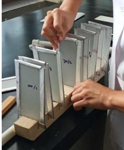
**Figura 3.11** Proceso para acomodar las láminas en las ranuras de la pieza de madera.
