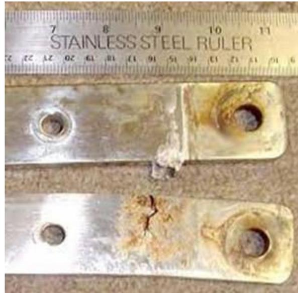
**Figura 2.11 Placas con corrosión en cavidades.**
