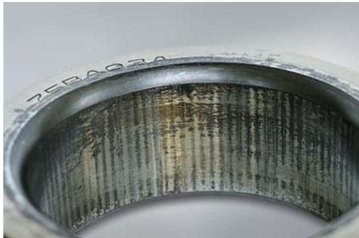
**Figura 2.8** Anillo interior de un rodamiento de bolas de contacto angular, presenta corrosión por contacto en la superficie del interior causado por ajuste inadecuado. Fuente: nskamericas.com.
