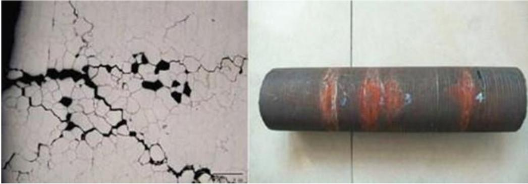
**Figura 2.5 Corrosión intergranular bajo un microscopio y en tubos de acero SAE 304. Fuente: hynickelalloy.com.**
