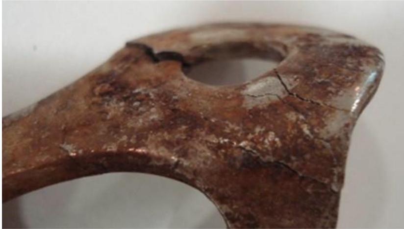
**Figura 2.6 Anclaje sujeto a agrietamiento por corrosión bajo tensión. Fuente: nitty-gritty.it.**
