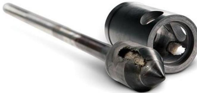
**Figura 2.9 Daño de cavitación en válvulas. Fuente: emerson.com.**
