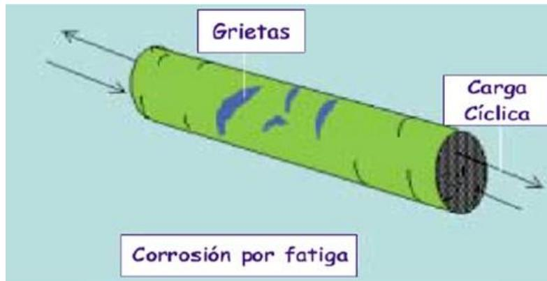
**Figura 2.7** Las tensiones cíclicas y el medio corrosivo conducen a la rotura de las capas pasivas que favorece la formación y el desarrollo de grietas.
