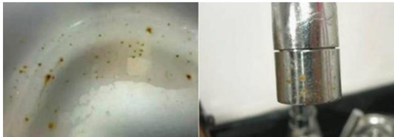
**Figura 2.10 Fregadero de acero inoxidable con picaduras de corrosión. Fuente: worldironsteel (2018).**
