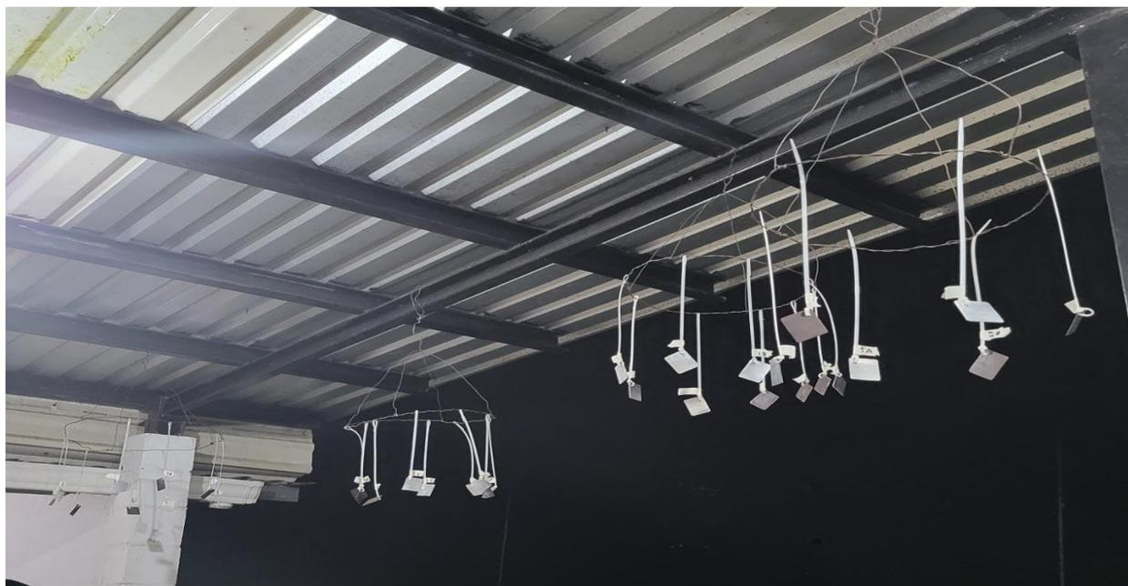
**Figura A. 4** Sistema de monitoreo de la corrosión
