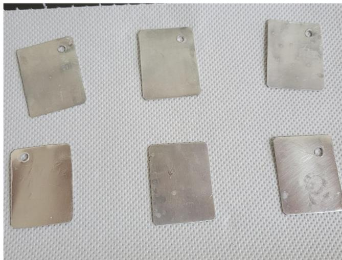
**Figura 2. 32** Testigos de aluminio luego de 720 horas de exposición al ambiente corrosivo marino frente al testigo no expuesto
