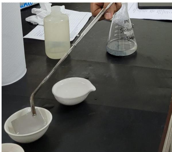
**Figura 2. 15** Inmersión de testigos de acero inoxidable en solución neutra
