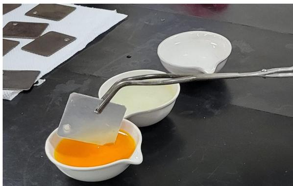
**Figura 2. 2** Inmersión de testigos de aluminio en solución ácida para la remoción de productos de corrosión
