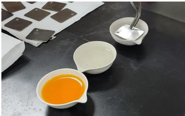
**Figura 2. 4** Inmersión de testigos de aluminio en agua destilada
