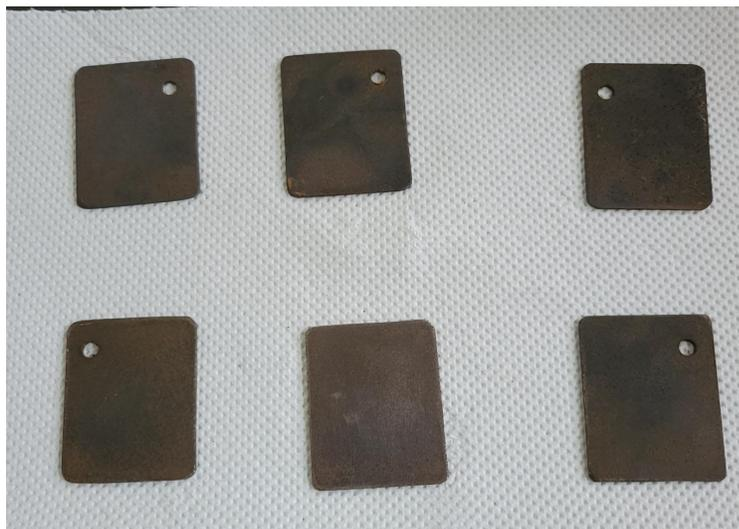
**Figura 2. 30** Testigos de hierro luego de 720 horas de exposición al ambiente corrosivo marino frente al testigo no expuesto
