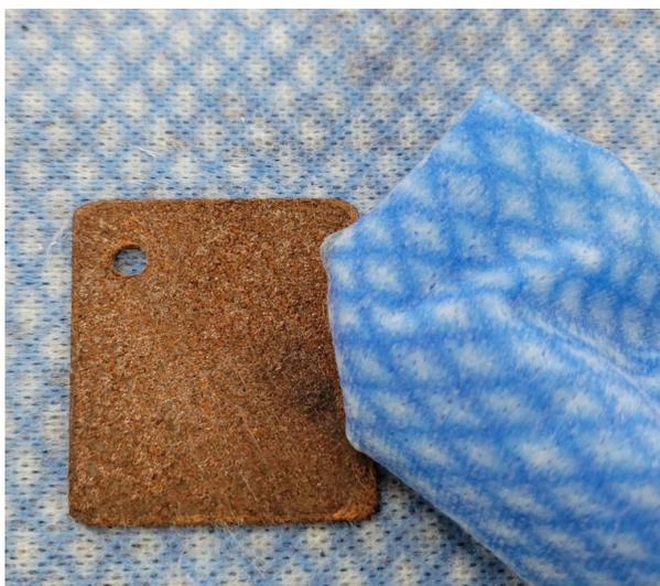
**Figura 2. 11** Limpieza de testigo de hierro con acetona
