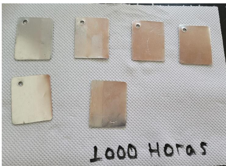
**Figura 2. 35** Testigos de aluminio luego de 1,000 horas de exposición al ambiente corrosivo marino frente al testigo no expuesto.
