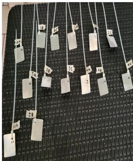
**Figura A. 1** Probetas de Acero Inoxidable
