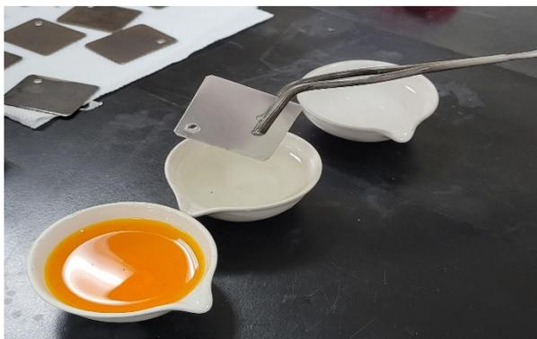
**Figura 2. 3** Inmersión de testigos de aluminio en solución neutra para eliminar remanentes de la solución ácida
