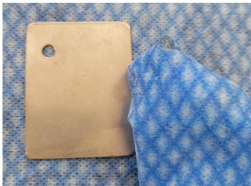
**Figura 2. 13** Limpieza de testigos de acero inoxidable con tolueno
