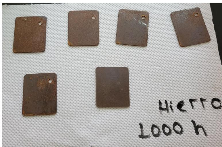
**Figura 2. 33** Testigos de hierro luego de 1,000 horas de exposición al ambiente corrosivo marino frente al testigo no expuesto
