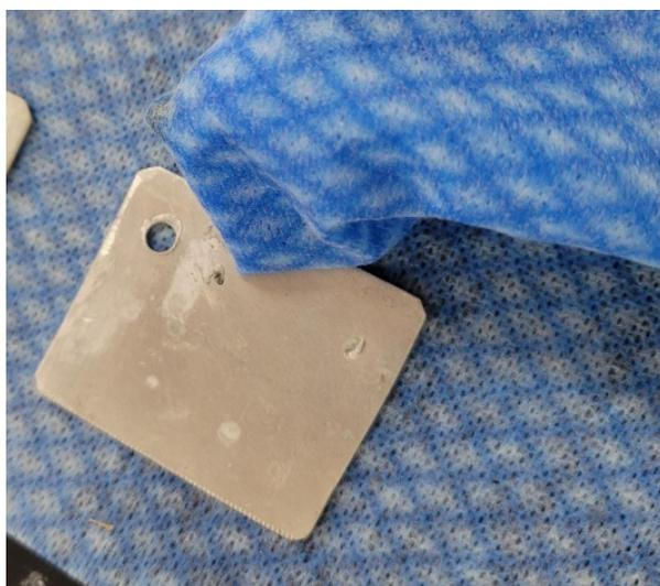
**Figura 2. 17** Limpieza de testigo de acero inoxidable con acetona
