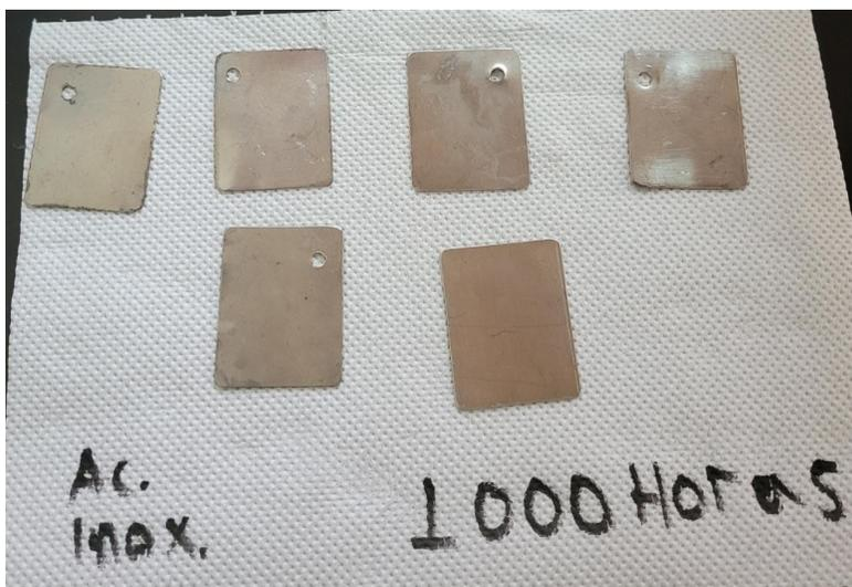
**Figura 2. 34** Testigos de acero inoxidable luego de 1,000 horas de exposición al ambiente corrosivo marino frente al testigo no expuesto
