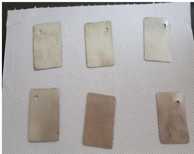
**Figura 2. 31** Testigos de acero inoxidable luego de 720 horas de exposición al ambiente corrosivo marino frente al testigo no expuesto
