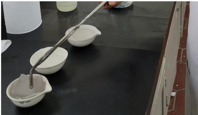
**Figura 2. 14** Inmersión de testigos de acero inoxidable en solución alcalina
