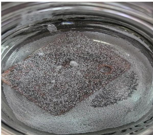
**Figura 2. 8** Testigo de hierro sumergido en solución alcalina para remoción de productos de corrosión
