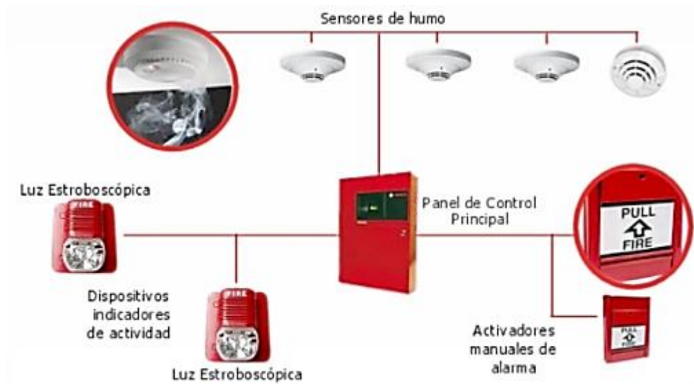
Ilustración 18 Elementos básicos del sistema de alarma contra incendio
