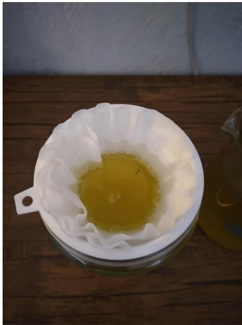
**Ilustración C.4 Proceso de filtración del oleato**
