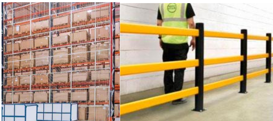
Figura 21. Mallas anti caída y separadores físicos.
