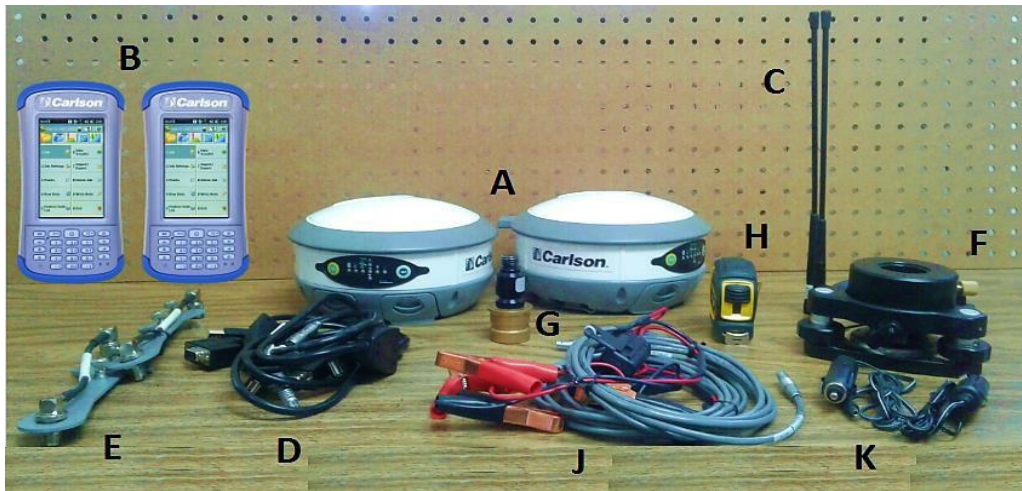
Figura 41. Equipo GPS con sus respectivos accesorios y colectores usados en el levantamiento RTK.
