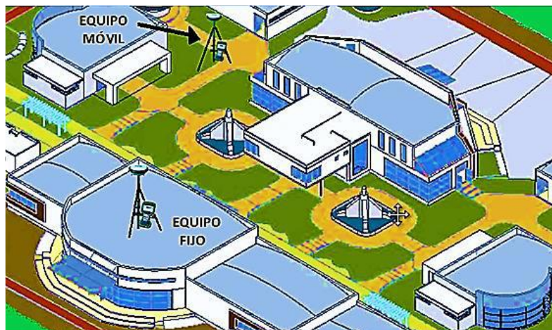
Figura 24. Ubicación recomendada para receptor Base y Móvil en técnica RTK.
