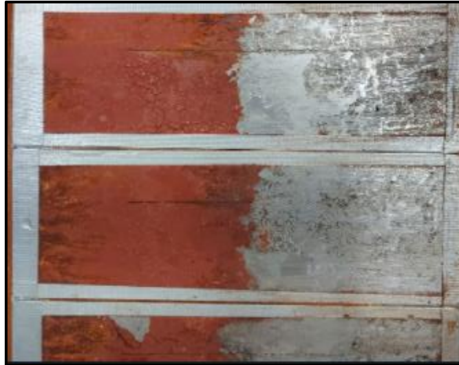
Figura 3.2. Procedimiento anterior a la toma de mediciones para determinación de incisión en la corrosión.
