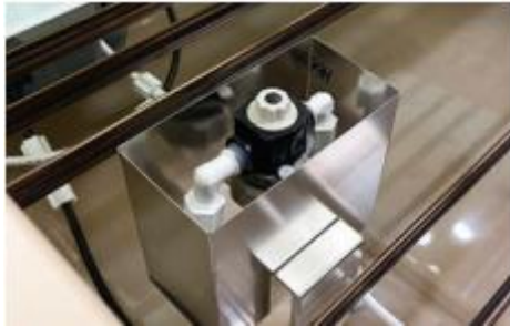
Figura 2.6. Esprea de niebla en máquina de intemperismo Q-FOG. Fuente: (Q-LAB, 2021)
