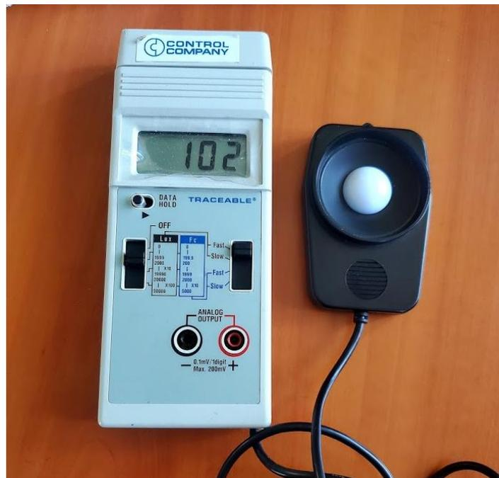
El levantamiento se realizó en cada una de las áreas de trabajo tomando en cuenta la posición y la altura a la que el trabajador necesita o requiere de iluminación que es aproximadamente 1.20 m a nivel del piso terminado.
