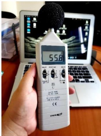
El levantamiento se realizó en cada una de las áreas de trabajo tomando en cuenta la posición y la altura a la que el trabajador tiene su cabeza, específicamente sus oídos, que es aproximadamente 1.70 m a nivel del piso.
