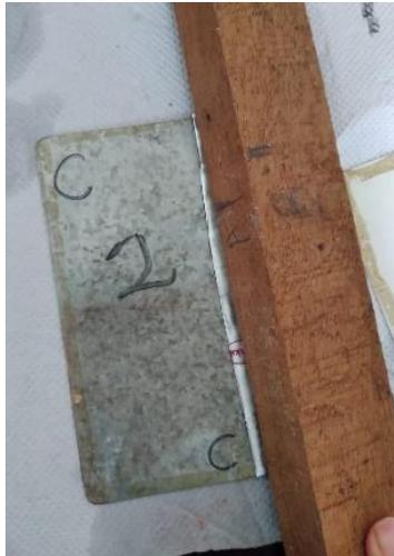
*Figura 3-27: Cinta tapagoteras presionada con un listón de madera.*
