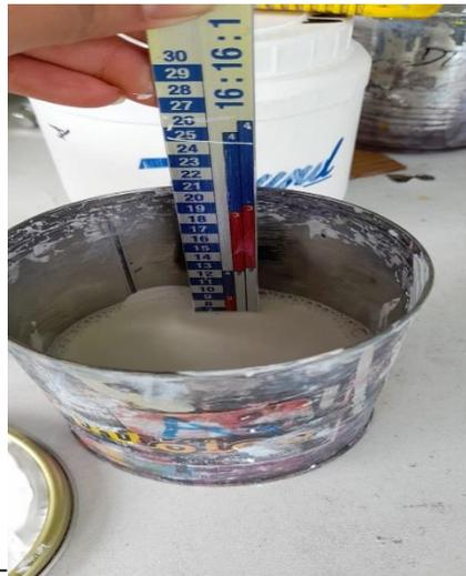
Figura 3-6: Medición de las partes de pintura y agua
