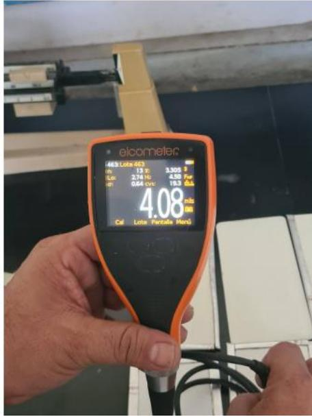
*Figura A.5: Medición de espesor de película del producto B.*
