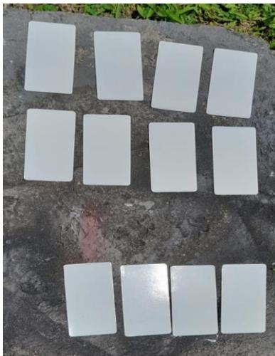
*Figura 3-8:* Secado de láminas después de la aplicación de la primera capa de pintura.
