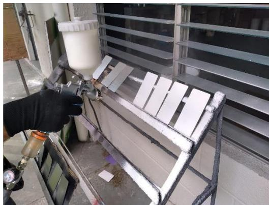
Figura 3-7: Aplicación de pintura con pistola.
