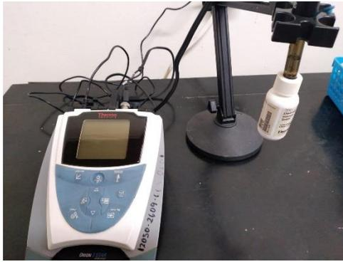
*Figura 3-21: pH-metro utilizado para el control del pH*
