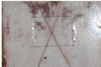
*Figura 3-30: Área marcada para retirar la pintura aplicada.*
