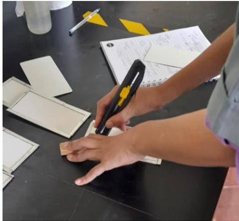
*Figura 3-14: Realización de un corte en el recubrimiento.*
