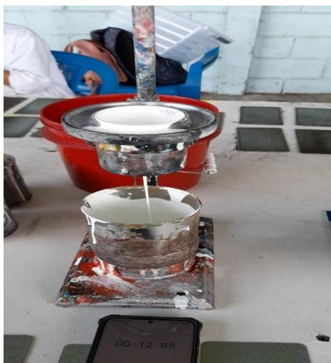
*Figura 3-5:* Medición del tiempo de caída de los productos de estudio.
