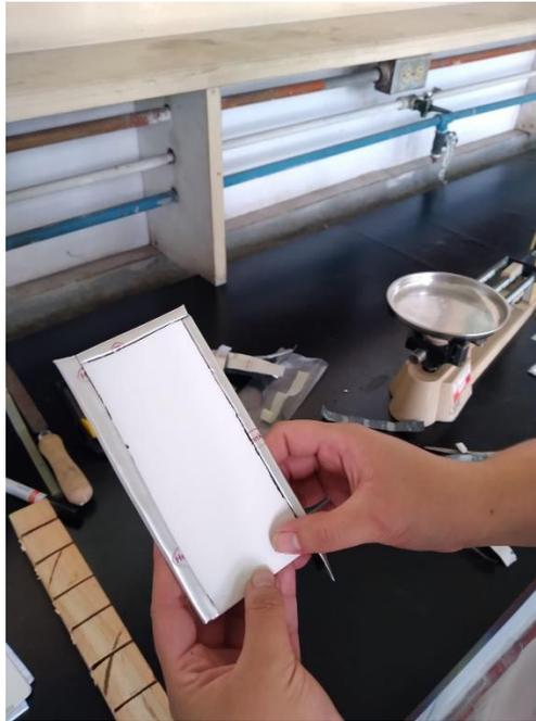
*Figura 3-16:* Adición de la cinta tapagotas a las láminas.
