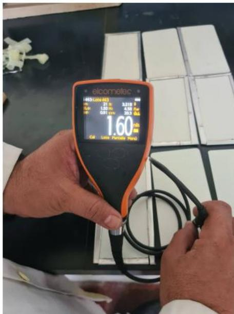
*Figura A.6: Medición del espesor de película del producto C.*
