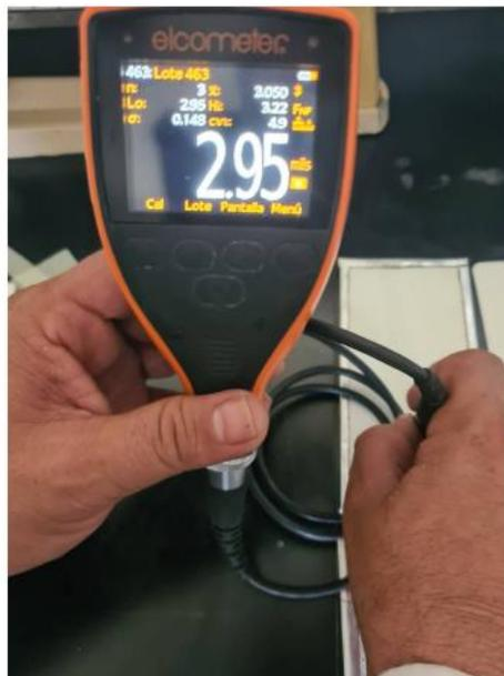
*Figura A.4:* Medición del espesor de película seca del producto A.
